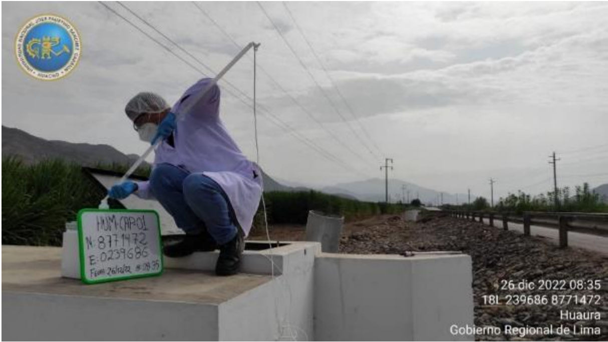
Figura 46. Toma de muestra de agua con el instrumento bailers.
