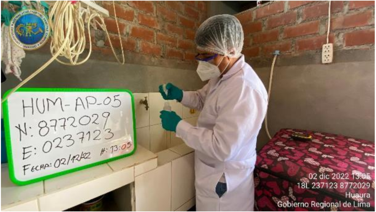
Figura 50. Adición de ácido nítrico ( \text{HNO}_3 ) para preservar la muestra.
