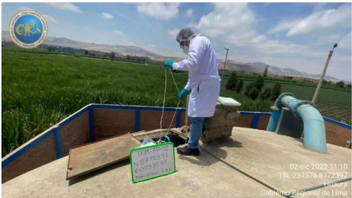
Figura 45. Uso del instrumento bailers para recolección de muestras de agua.
