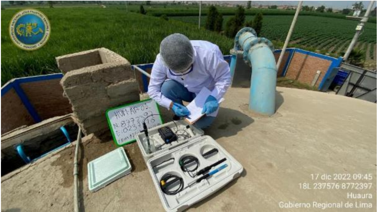
Figura 54. Medición de la conductividad in situ.
