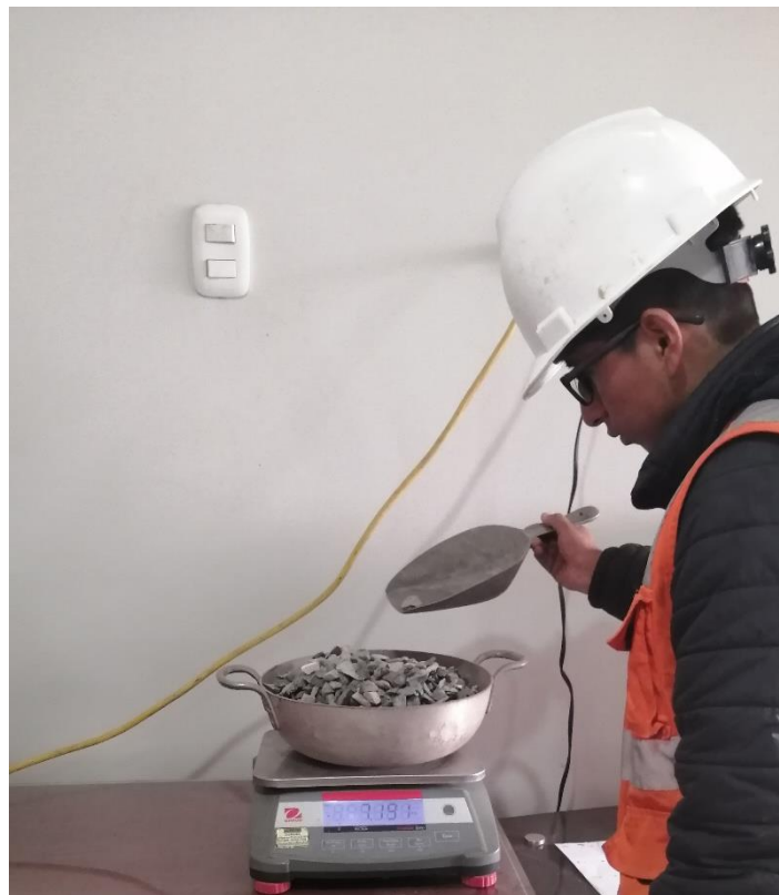
Fotografía 2. Peso del agregado grueso
