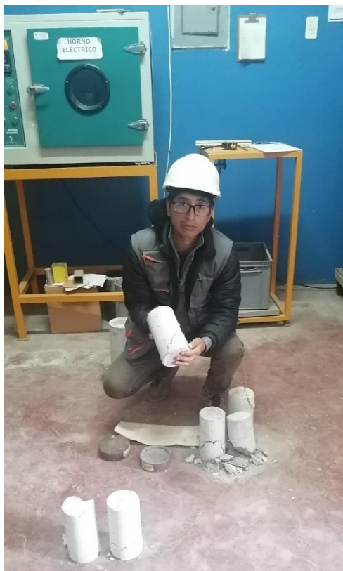
Fotografía 12. Rotura de los testigos
