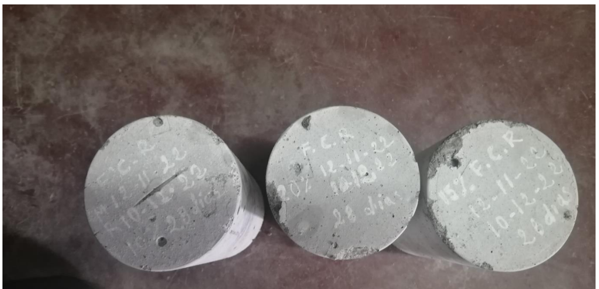
Fotografía 10. Testigos para el ensayo a compresión
