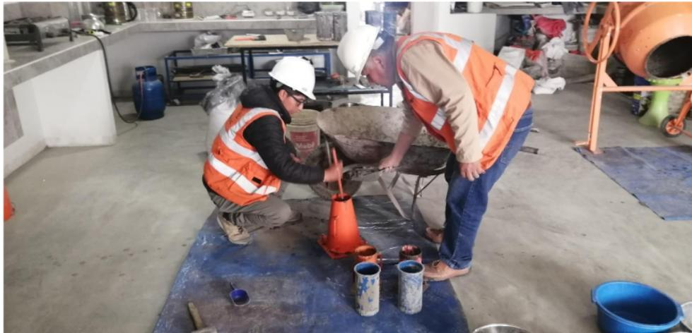
Fotografía 7. Medición del Slump
