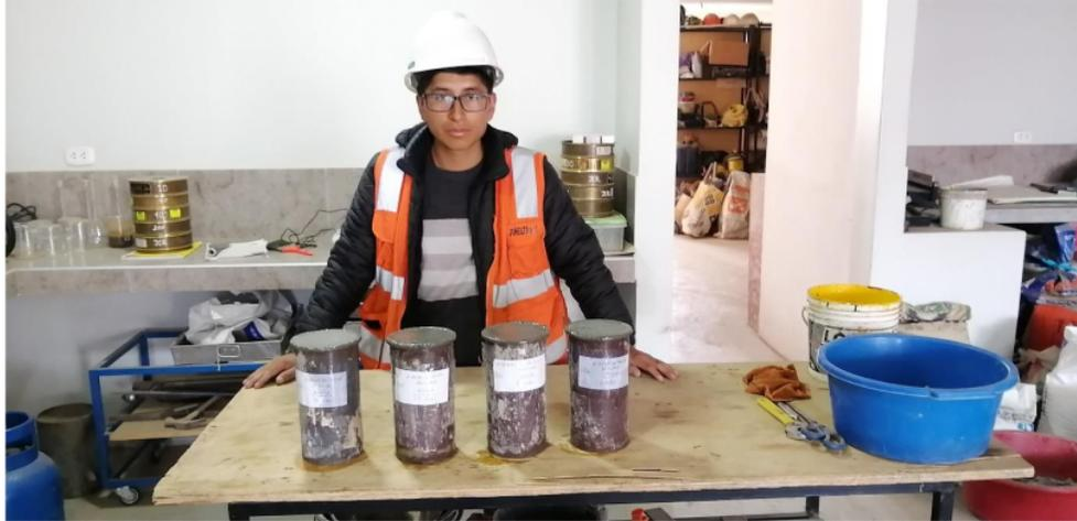
Fotografía 10. Testigos para el ensayo a compresión
