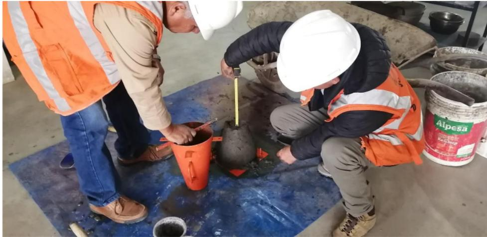
Fotografía 8. Llenado de las probetas
