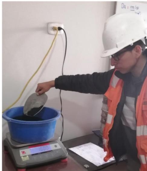
Fotografía 5. Mezcla de los agregados con el caucho reciclado
