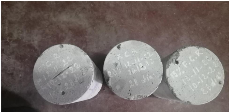
Fotografía 11. Ensayo de rotura a compresión
