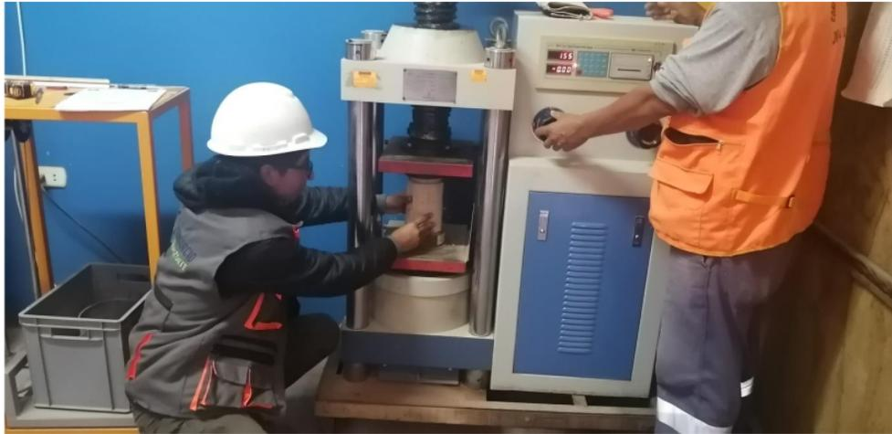
Fotografía 12. Rotura de los testigos
