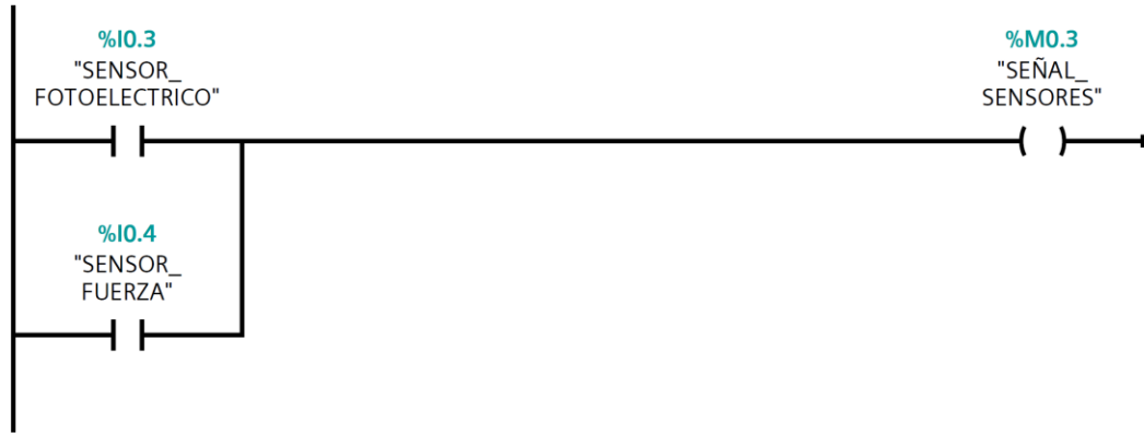
Figura 17. Configuración del sensor fotoeléctrico y de fuerza
