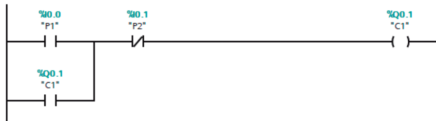
Figura 2: Programa para arranque y enclavamiento de motor
