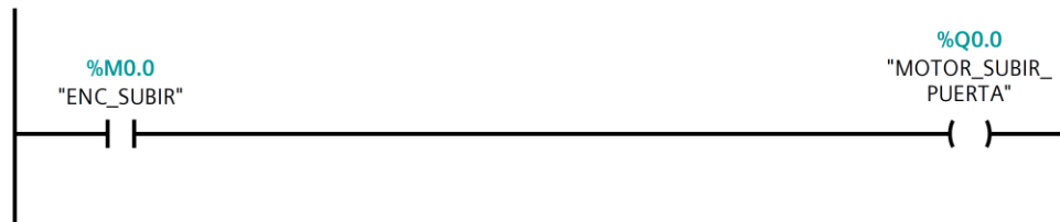
Figura 13. Activación de subida para la puerta enrollable
