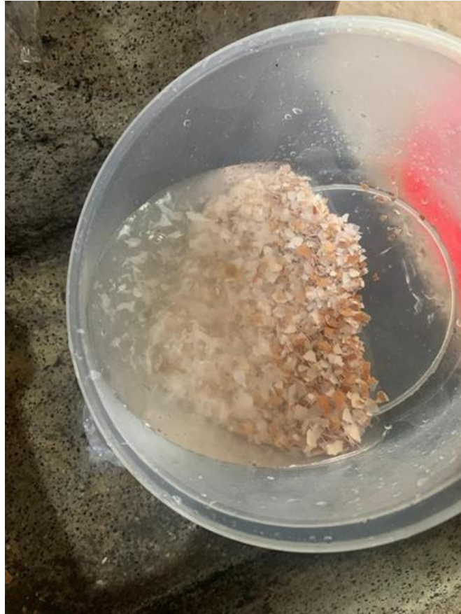
Figura 5: Fotografía del proceso de quite de la membrana.
