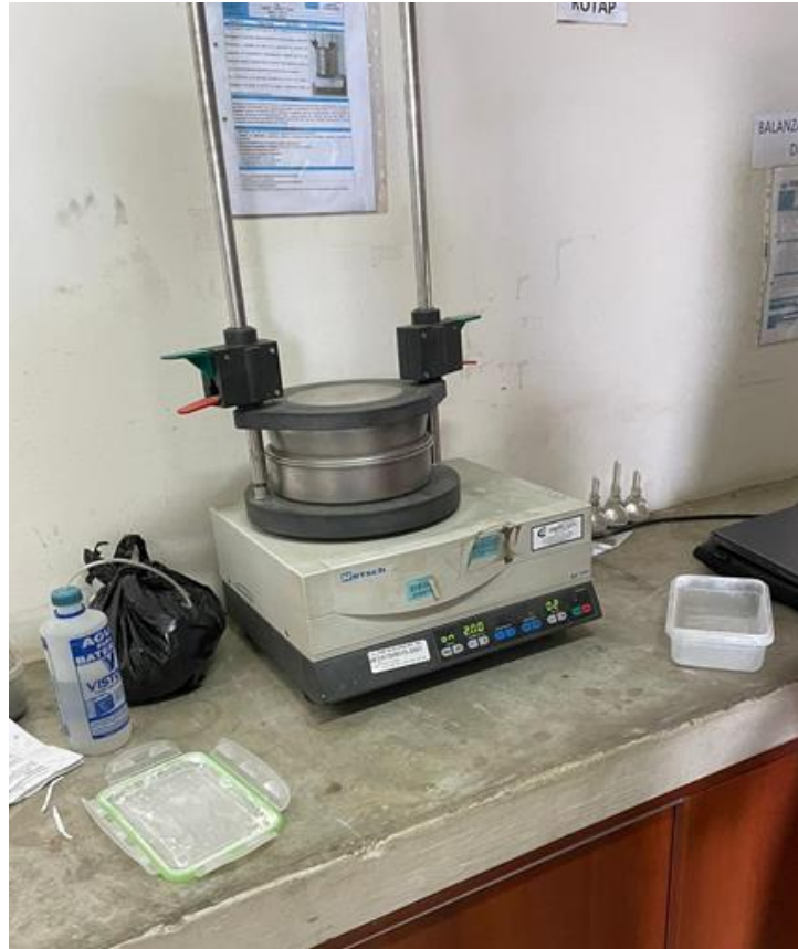
Figura 9: Imagen del Proceso de tamizado de la muestra pulverizada.
