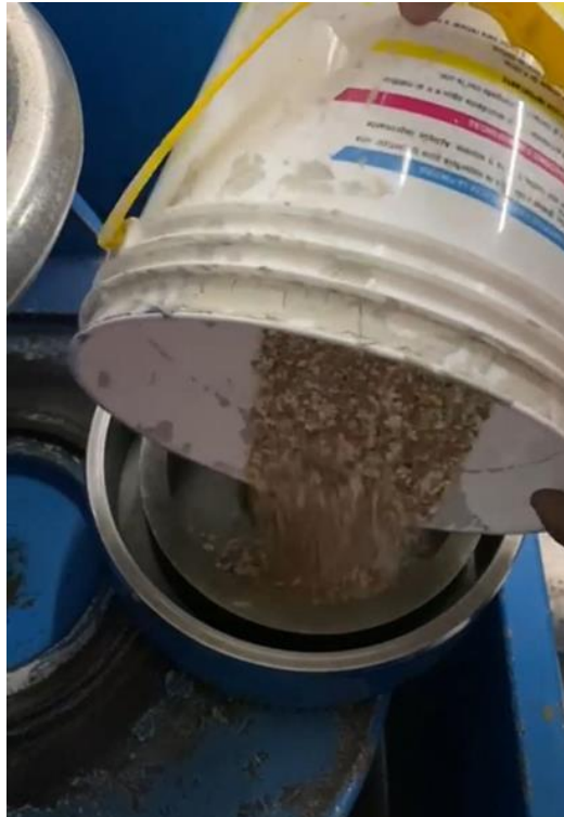
Figura 7: Imagen del vertimiento de la cáscara seca al molino de disco..
