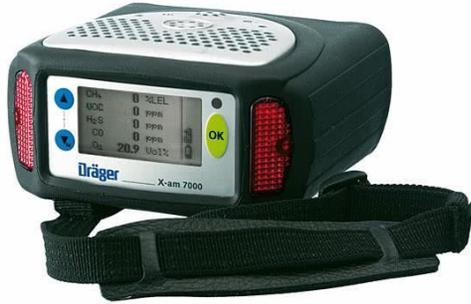
El Dräger X-am® 7000 es la solución para la medición continua y simultánea de hasta cinco gases. Es el compañero ideal en una gran variedad de aplicaciones donde es necesario realizar una detección fiable de oxígeno, gases tóxicos y gases y vapores inflamables.
