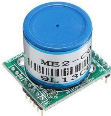
*Figura 9.* Módulo sensor de monóxido de carbono CO.
