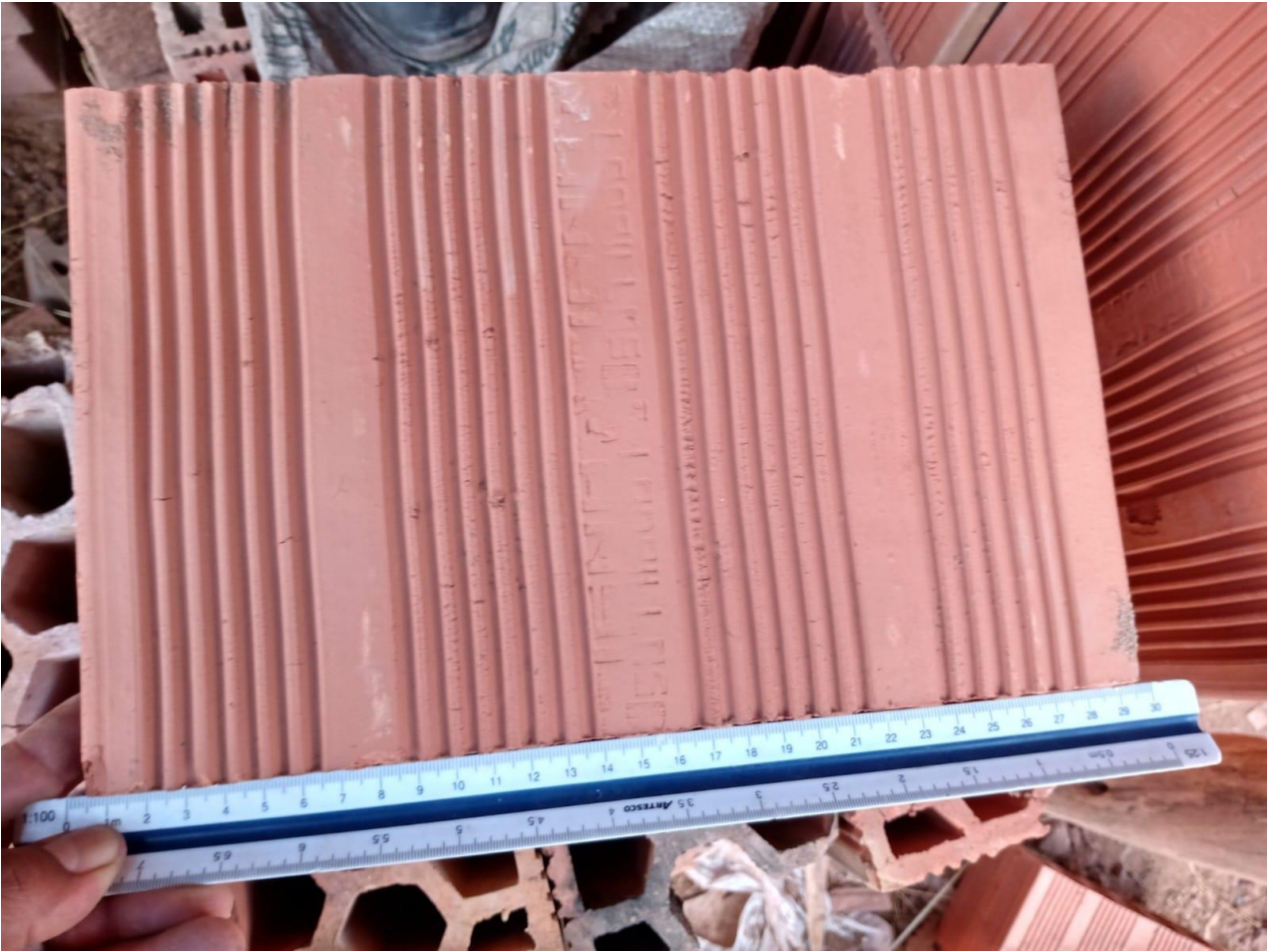
Foto 6: proceso de medición del ladrillo
