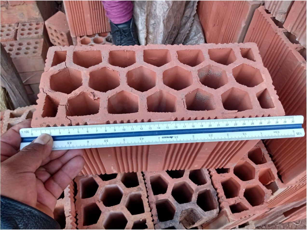
Foto 1: Prueba de Alabeo
