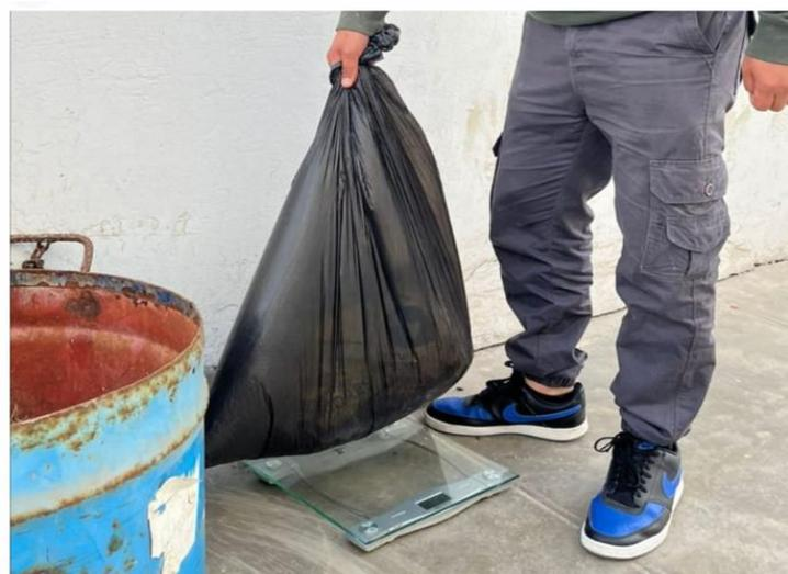
Foto 4. Determinación del Peso específico
