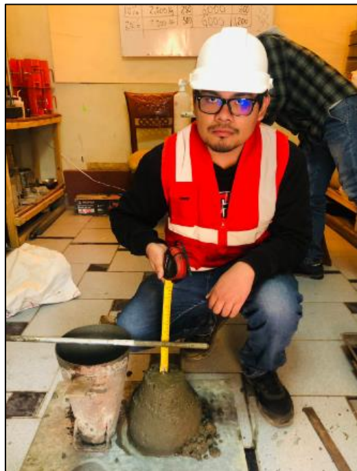
Figura N°12: : Ensayo de Asentamiento (Slump)
