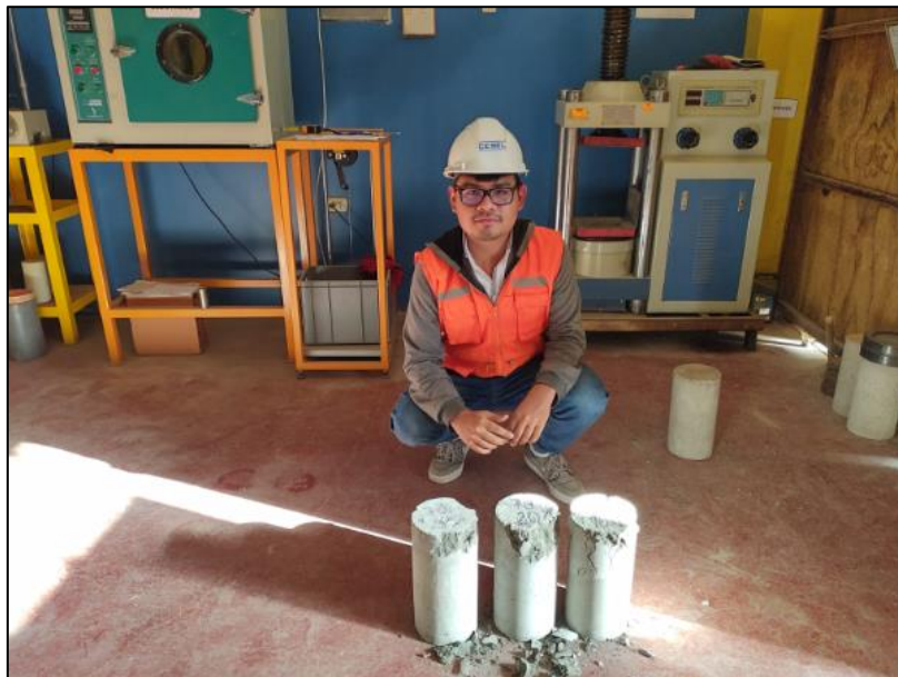
Figura N°19: Probetas de concretos rotas mediante prensa automática
