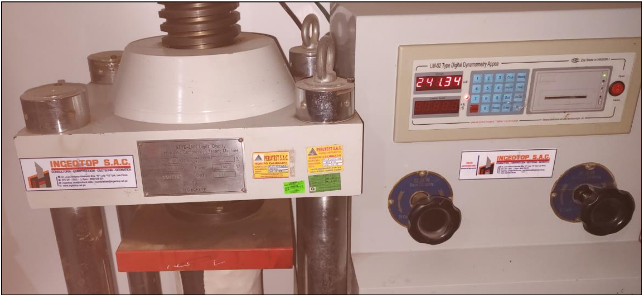
Figura N°20: Detalle del resultado de la compresión de una probeta en la máquina de prensa automática
