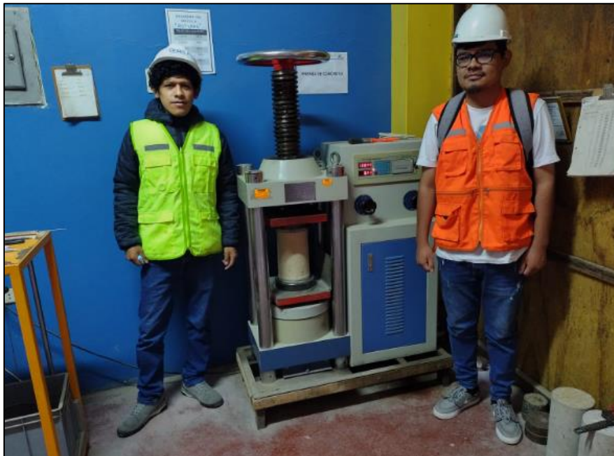
Figura N°17: Rotura de probetas de concreto
