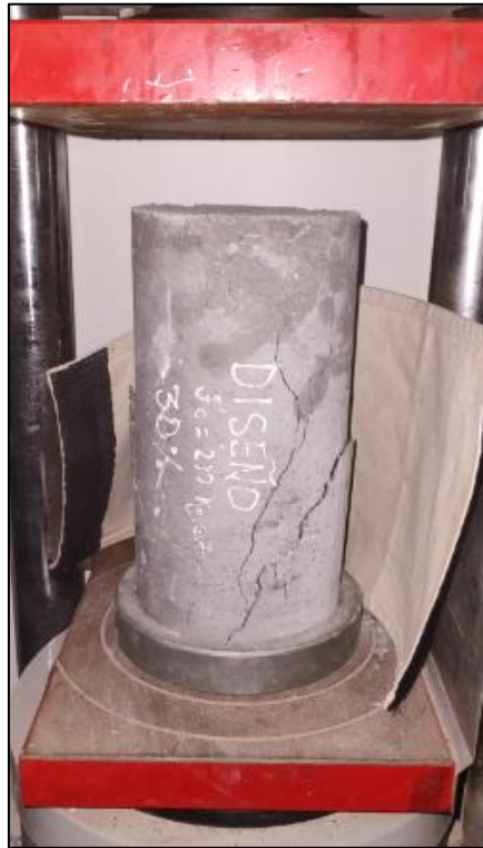
Figura N°18: Vista de la rotura de la probeta en la prensa de ensayo de compresión.
