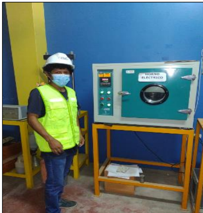
Figura 5: Secado de los Materiales para Diseño de Mezcla
