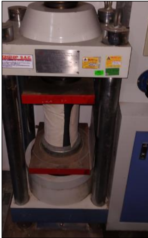
Figura N°16: Verificación de la posición de los testigos de concreto y su correcta protección con la almohadilla
