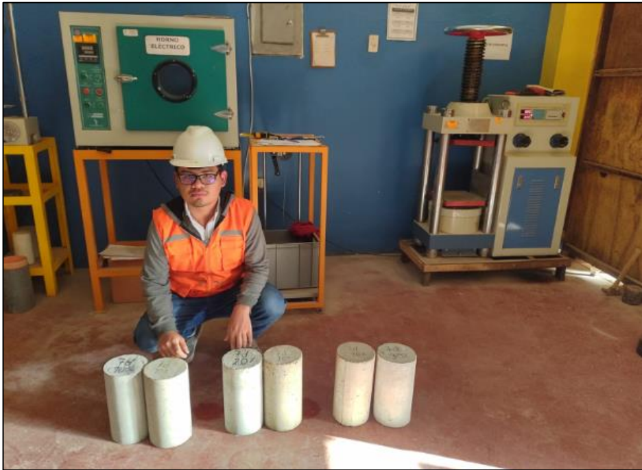
Figura N°14: Probetas de concreto con 10%,20% y 30 % adicionando la ceniza de bagazo y polvo de caucho junto la prensa de ensayo de compresión
