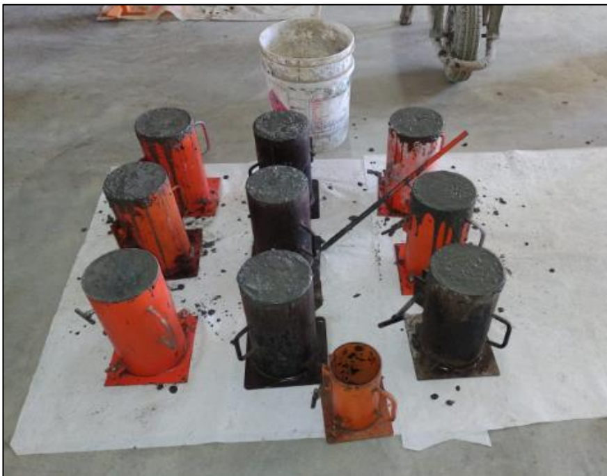
Figura N° 10 : Vaciado y chuceado en las probetas
