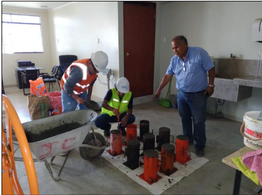
Figura N° 10 : Vaciado y chuceado en las probetas
