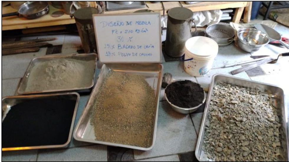
Figura N°8: Materiales del diseño de mezcla para concreto con ceniza de bagazo y polvo de caucho reciclado
