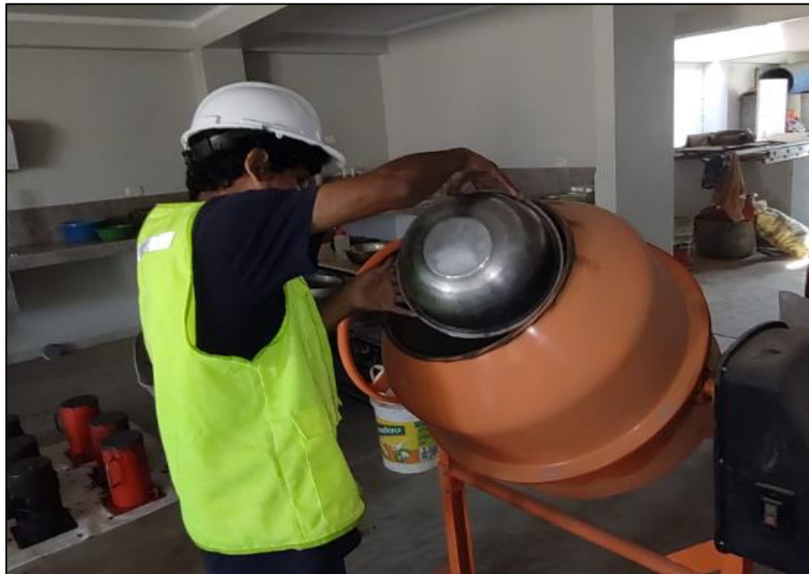
Figura N°9: Mezcla para concreto con adición de ceniza de bagazo de caña de azúcar y polvo de caucho
