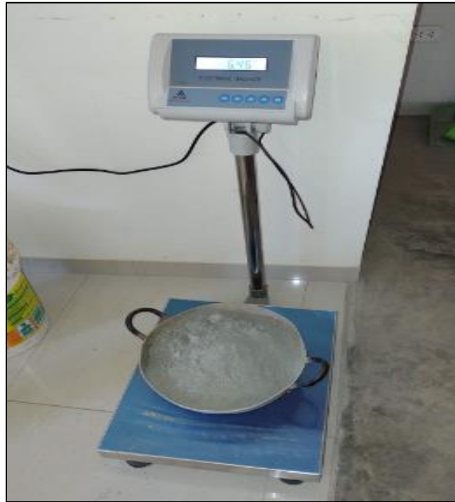
Figura 6: Peso del cemento de acuerdo al diseño de mezcla
