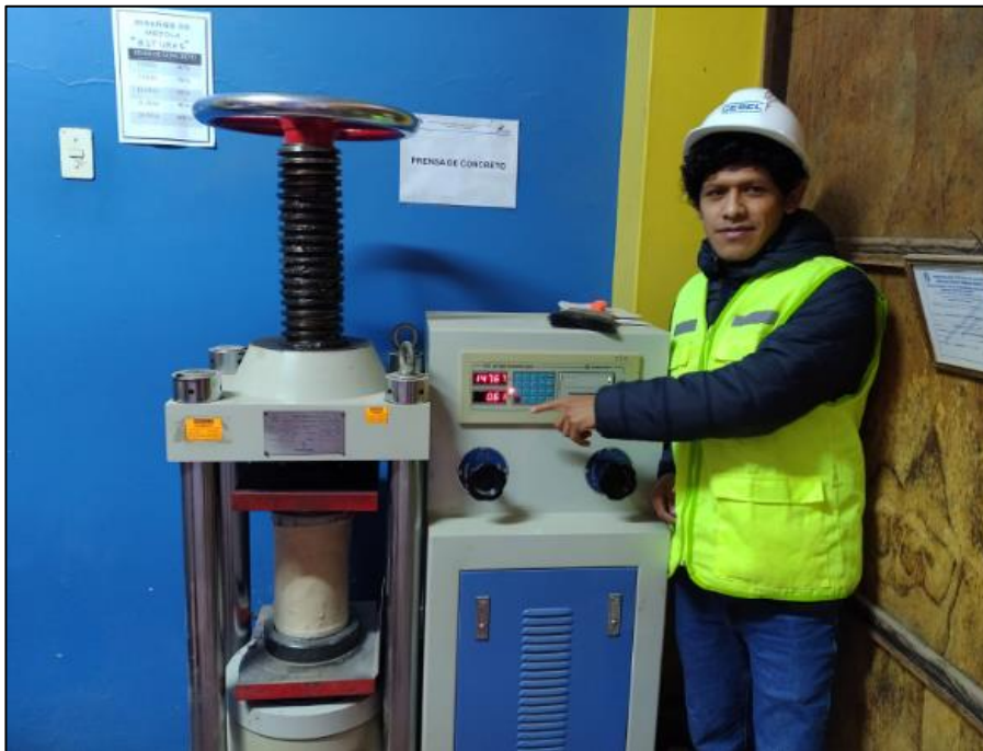
Figura N° 15: Colocación de probetas de concreto en la prensa automática
