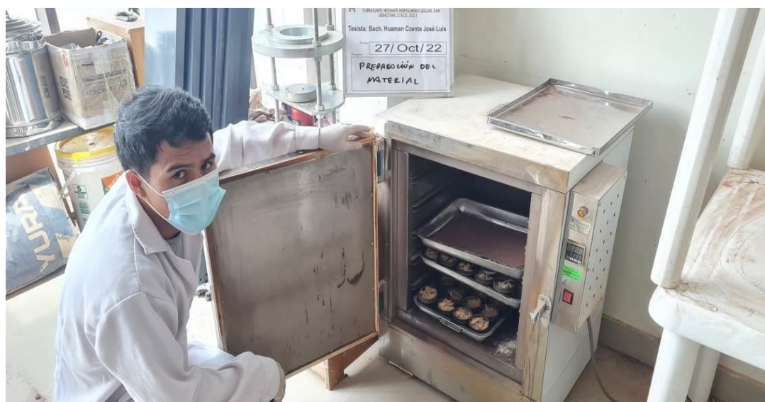
Figura 3 Secado del suelo
