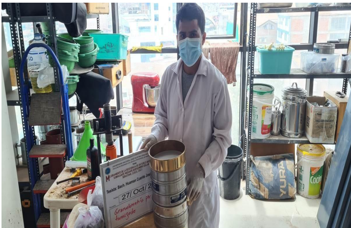
Figura 5 Granulometría por tamizado
