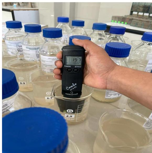
Figura 55. Medición inicial de pH, conductividad eléctrica, sólidos totales disueltos y temperatura
