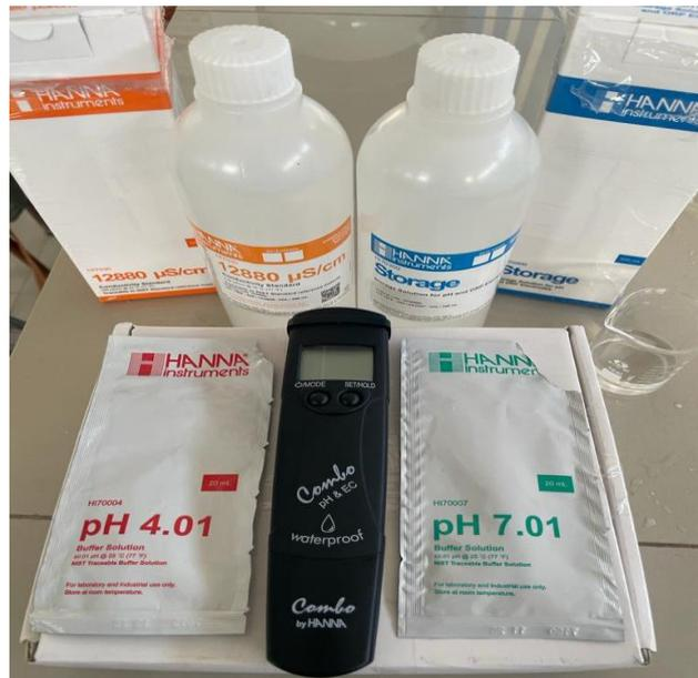
Figura 54. Calibración de multiparámetros con solución Buffer
