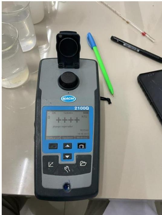
Figura 71. Equipo medidor de la turbidez muestra excedencia de UNT para resultados después de la aplicación de la moringa
