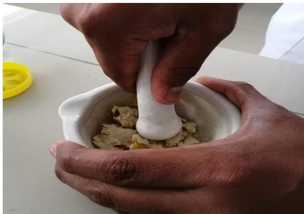
*Figura 42.* Pulverización mecánica del almidón
