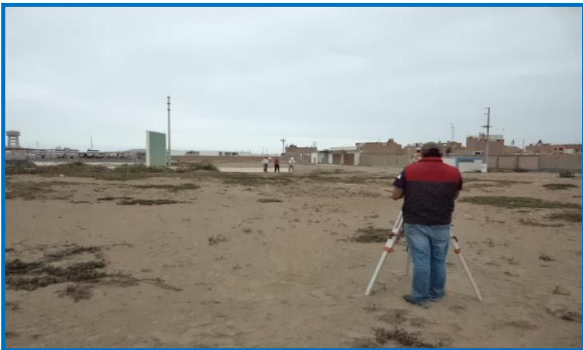
**Fotografía N°02:** Se aprecia el levantamiento topográfico de la superficie del terreno mediante el equipo topográfico de estación total.
