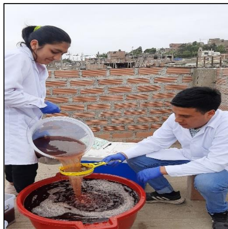
Figura 36. Filtrado de las aguas residuales (proceso unitario de desbaste)
