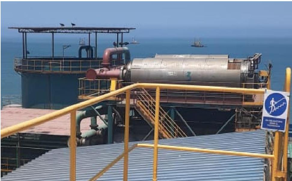
*Figura 33.* Tromells Secundarios (Separación de escamas)
