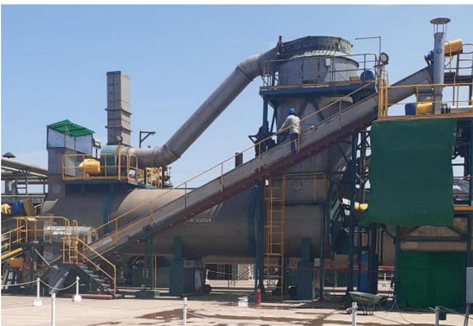
*Figura 17.* Secador de aire caliente
