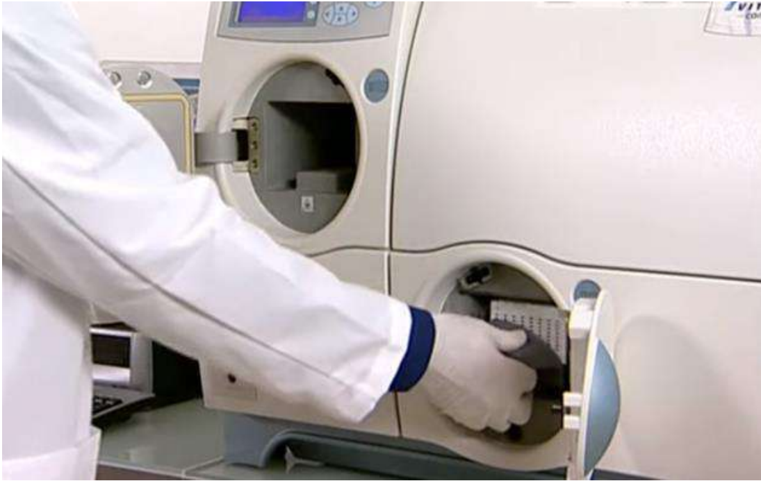
Figura 21. Sistema VITEK 2 con el Cassette con las muestras.
