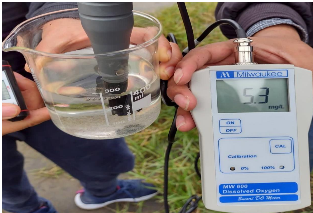
Figura 17: Medición de OD en el P3, toma uno. Nota. Fuente: Autoría propia.
