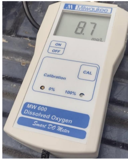
Figura 16: Medición de OD en el P5, toma dos. Nota. Fuente: Autoría propia.
