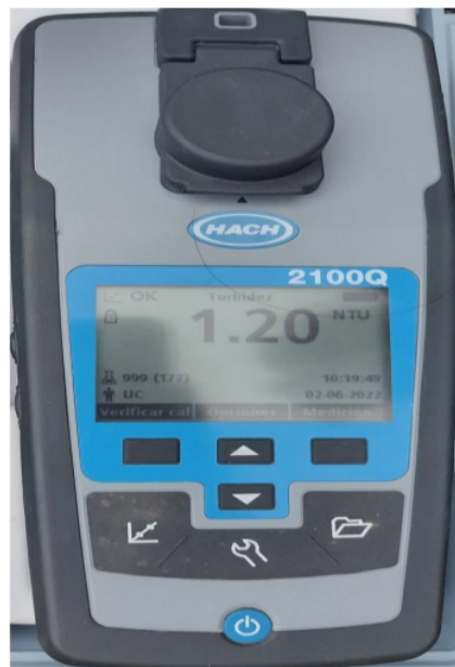
Figura 14: Medición de turbiedad P2, toma dos. Nota. Fuente: Autoría propia.
