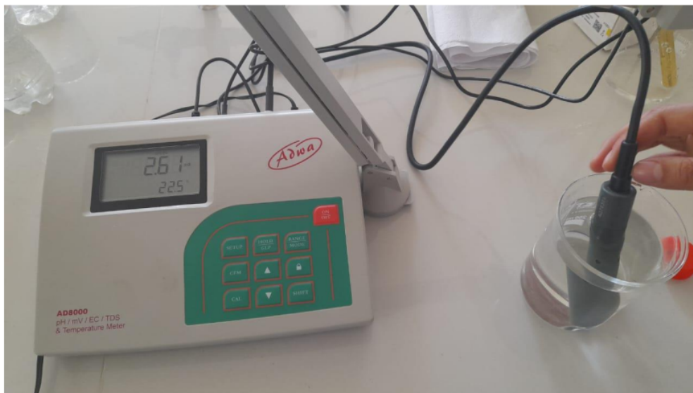
Figura 19: Medición de conductividad eléctrica. Nota. Fuente: Autoría propia.
