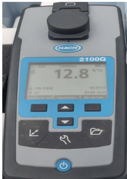
Figura 13: Medición de turbiedad P2, toma dos. Nota. Fuente: Autoría propia.
