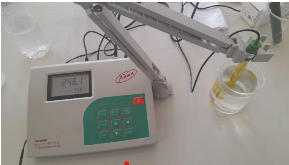
Figura 20: Medición de ORP. Nota. Fuente: Autoría propia.
