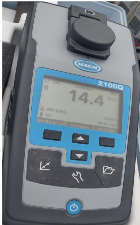
Figura 12: Medición de turbiedad P1, toma tres. Nota. Fuente: Autoría propia.
