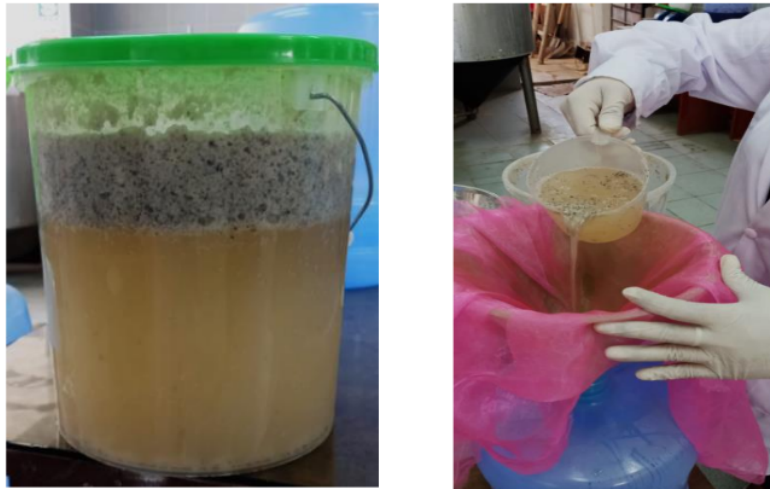
Figura Nro. 25. Trasvasar el mosto y el jugo de pitahaya (Selenicereus undatus) filtrado al fermentador Brewmart.
