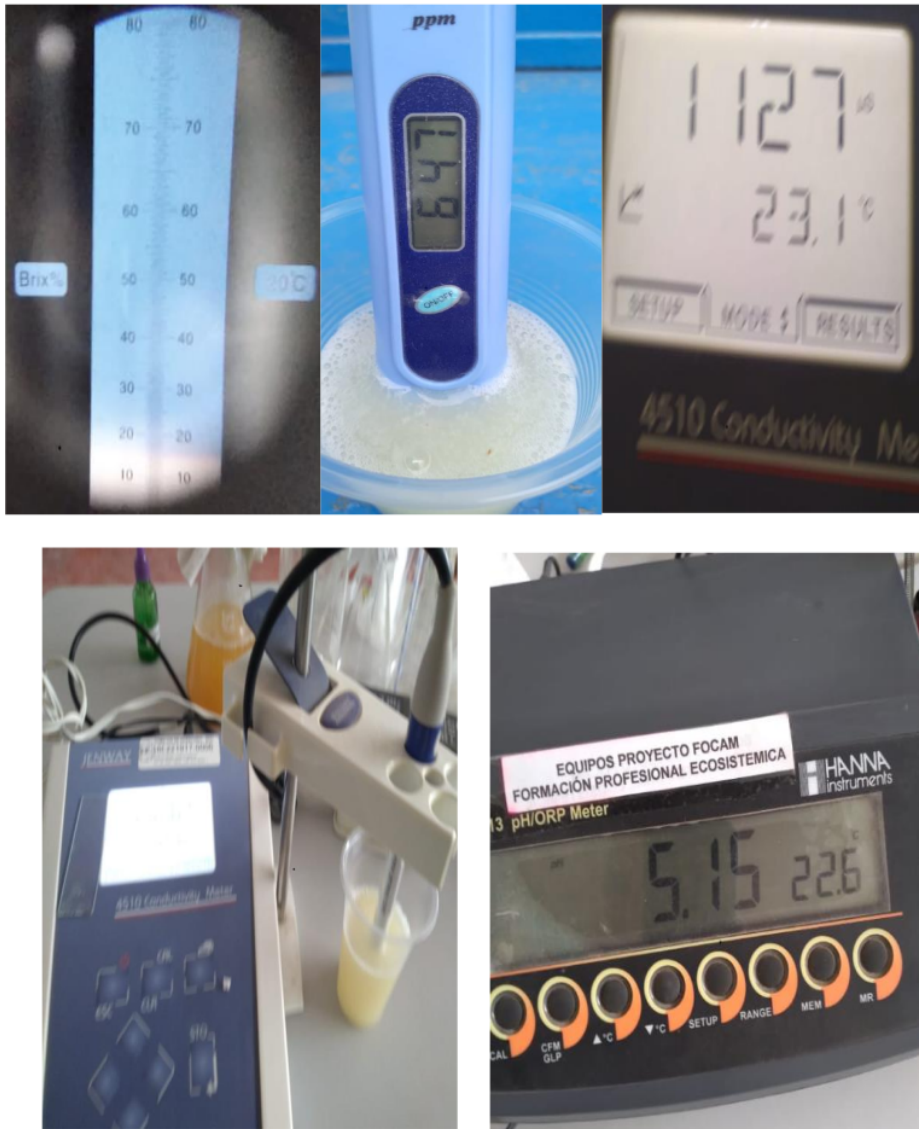
Figura Nro. 29. Control parámetros: Brix, TDS, C.E. pH, de calidad del néctar fruta Pitahaya (Selenicereus undatus)
