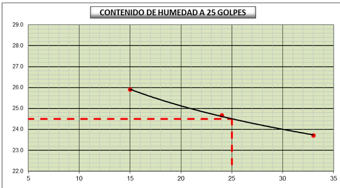
**Figura 7 Gráfico Contenido de Humedad a 25 Golpes con adición de cloruro de sodio**
