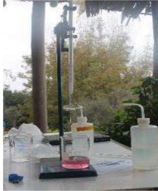
Figura 27: Determinación de ácido cítrico en la pulpa.
