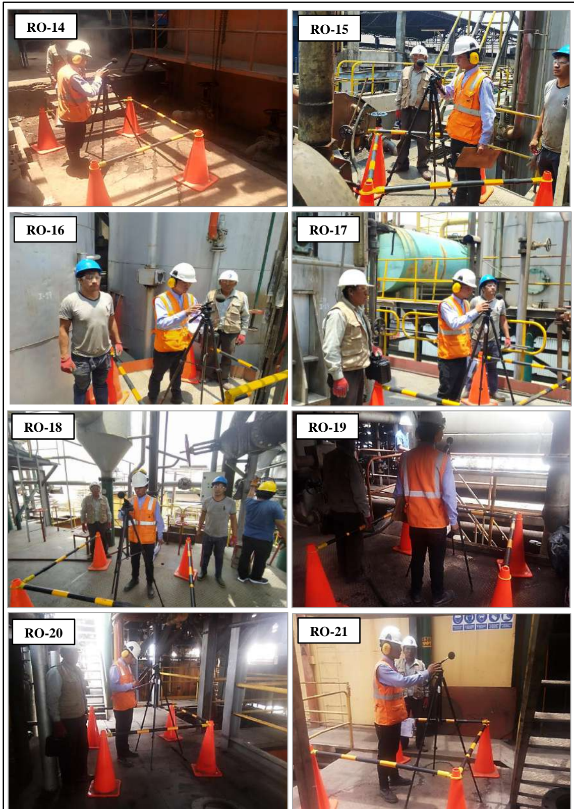
Figura 24. Medición del ruido ocupacional en el departamento de elaboración (Parte I). Fuente: Autoría propia.
