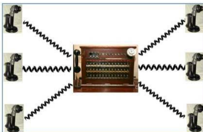
Figura. 4. Conexión de teléfonos a la centralita.
