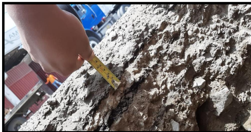
Imagen 13: Espesores de la capa del pavimento flexible
