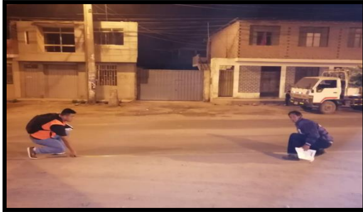
Imagen 17: Medición de las fallas en el pavimento
