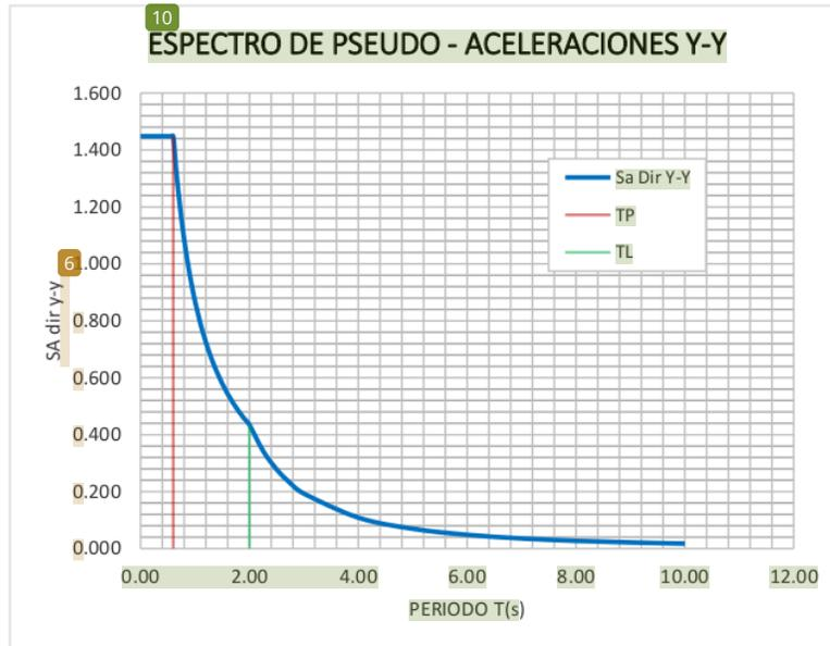
Figura 7: Espectro de aceleraciones en el sentido Y-Y
