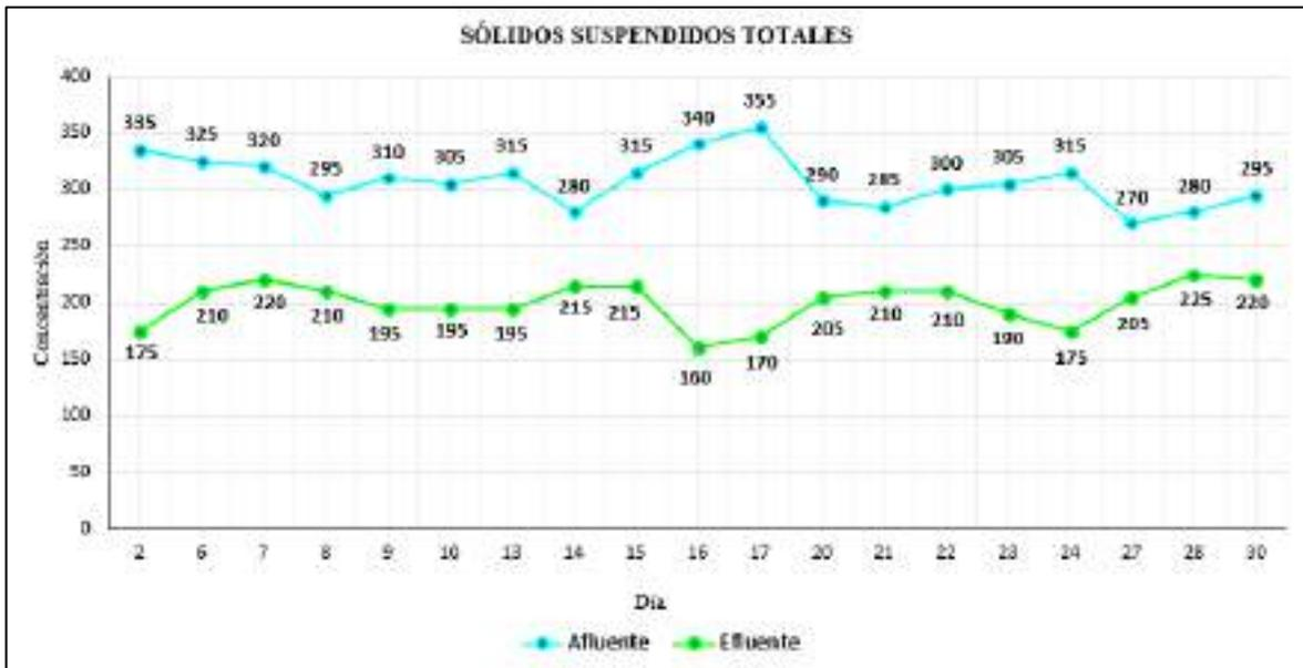
Figura 31. Concentración de sólidos suspendidos totales del afluente y efluente
