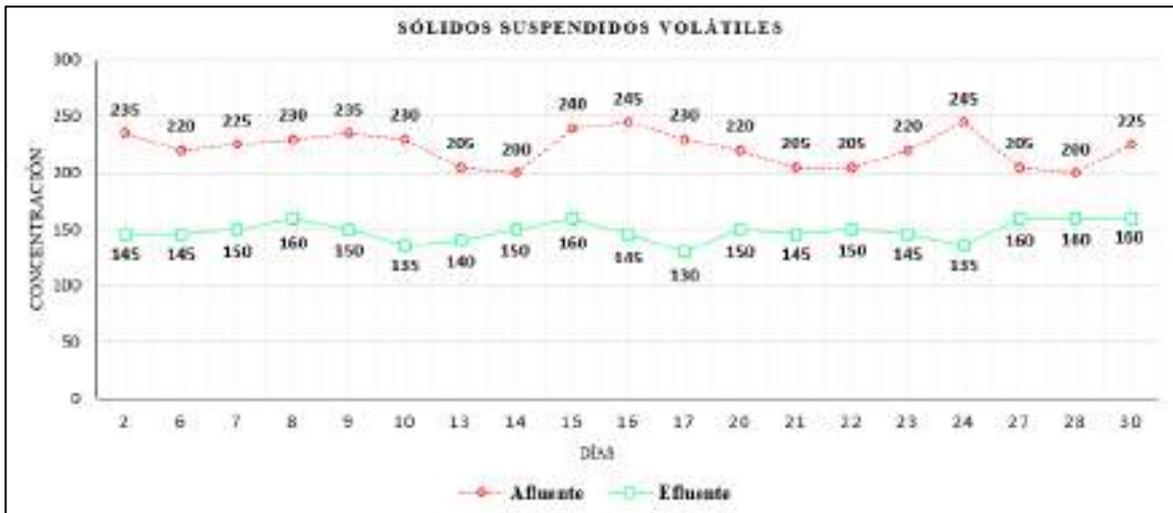
**Figura 33.** Concentración de sólidos suspendidos volátiles del afluente y efluente
