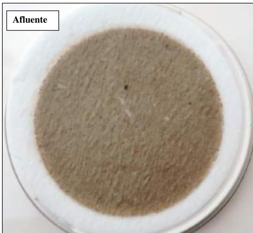
*Figura 55.* Papel filtro después de la filtración
