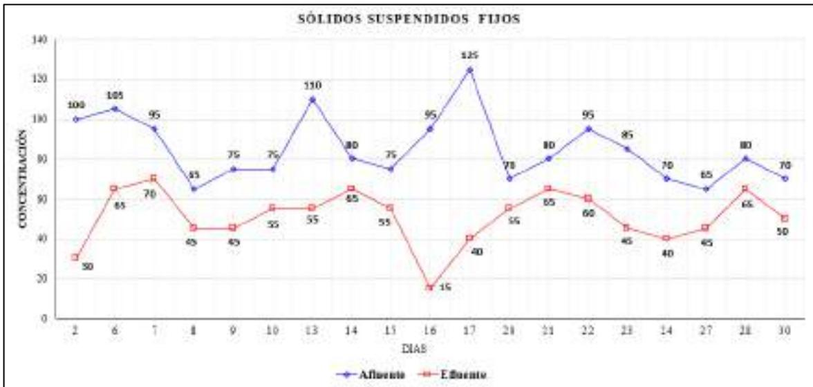
Figura 32. Concentración de sólidos suspendidos fijos del afluente y efluente
