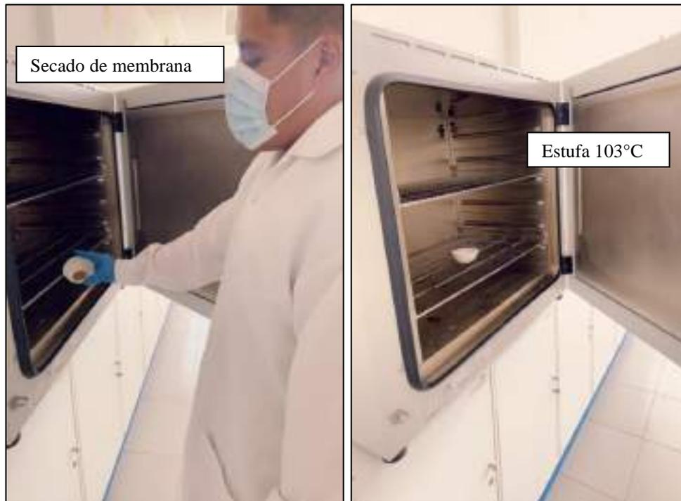
*Figura 24.* Proceso de secado de membrana a 103°C
