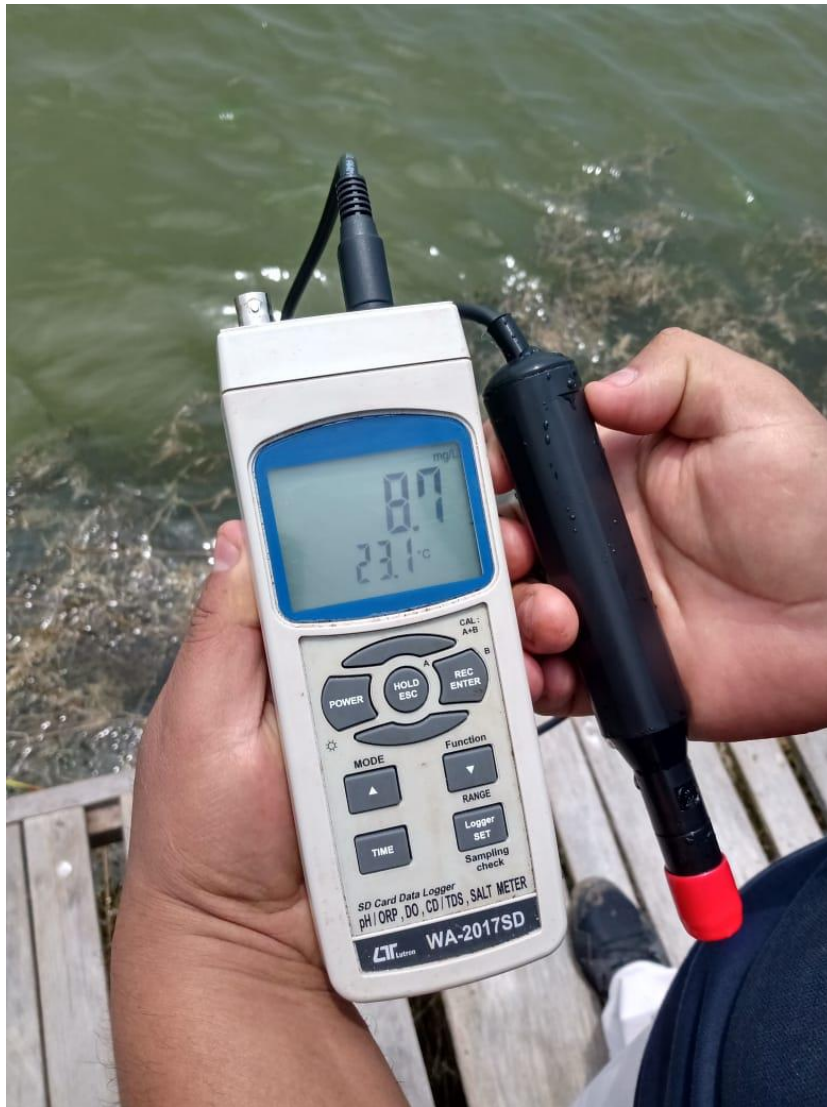
Figura 21. Uso del multiparámetro de campo para determinar los parámetros fisicoquímicos del agua superficial del HAMM. Nota: elaboración propia
