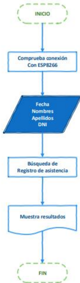
Figura 15 Diagrama de flujo búsqueda de asistencias en base de datos
