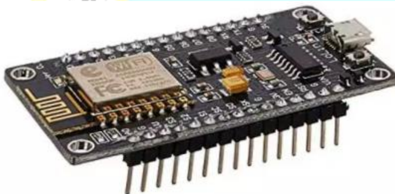
Figura 2 Características del esp8266
