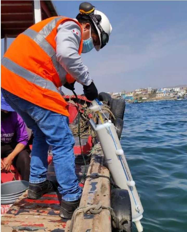
Figura 27. Toma de muestra de a 500 m a nivel Fondo, uso de la botella Niskin
