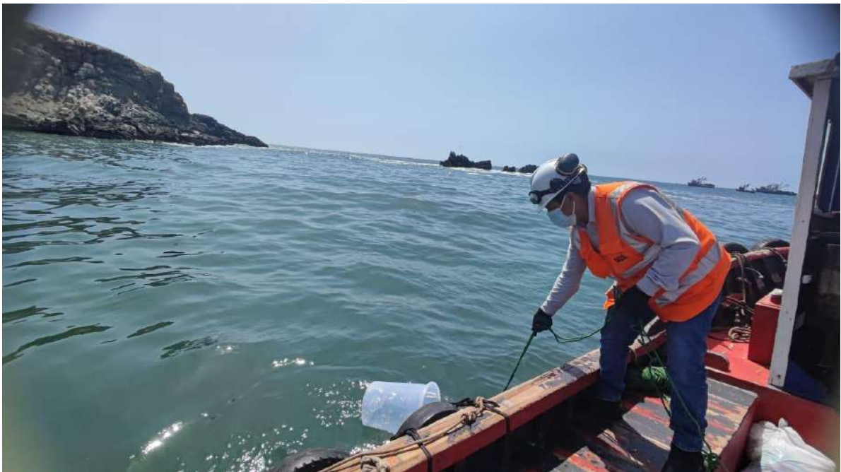
Figura 24. Toma de muestra de a 250 m a nivel superficial, uso del balde.
