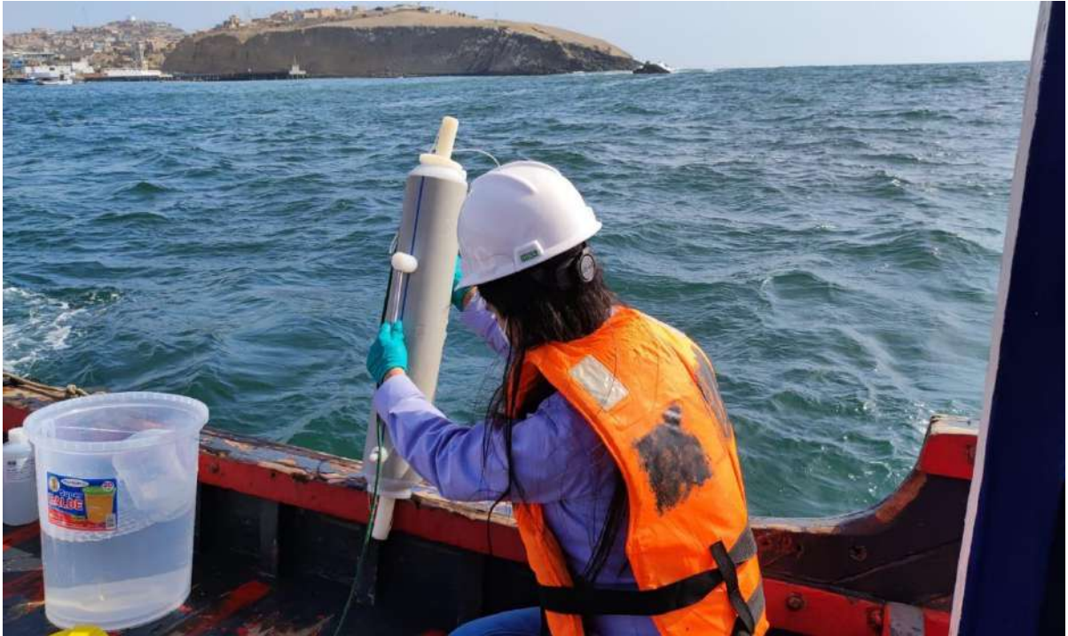
Figura 25. Toma de muestra de a 250 m a nivel Fondo, uso de la botella Niskin
