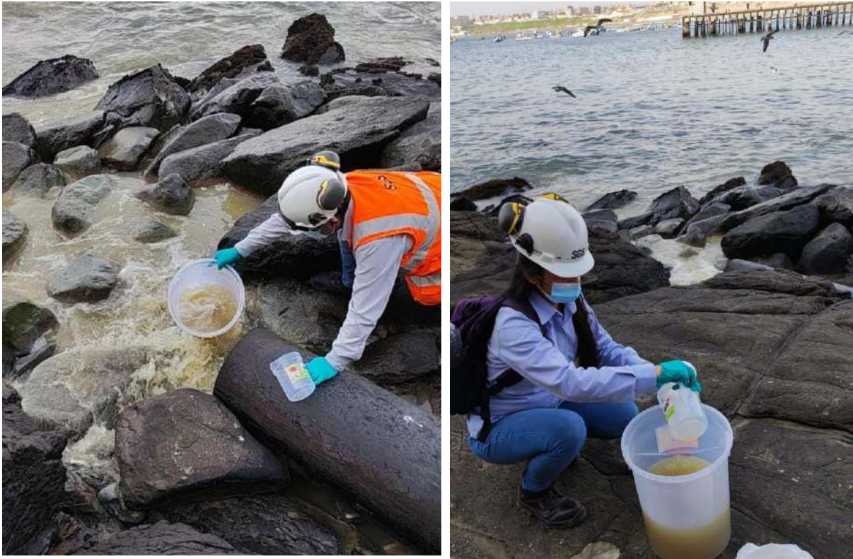
Figura 23. Toma de muestra del punto EF-01, tubería de descarga de la Bahía de Huacho.
