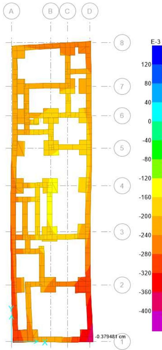
*Figura 28 Verificación por carga de servicio 1 y Diagrama de asentamiento del terreno.*
