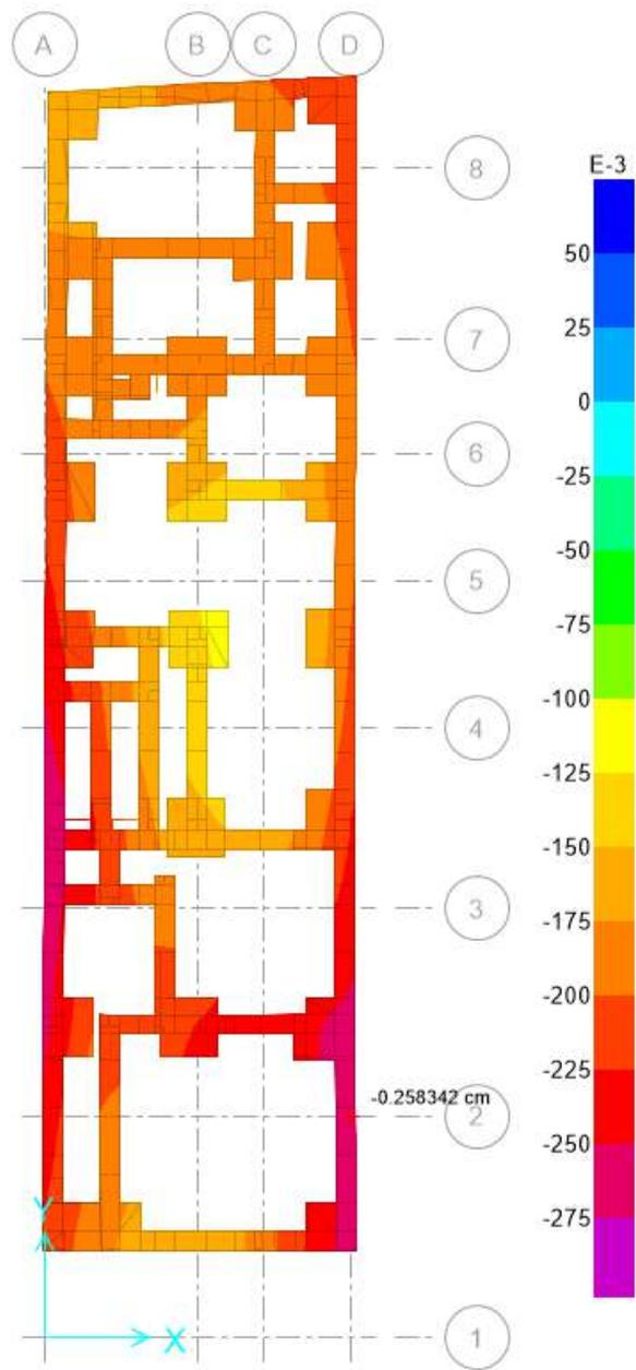
Figura 34 Diagrama de asentamiento del terreno por Servicio 4 y Servicio 5.
