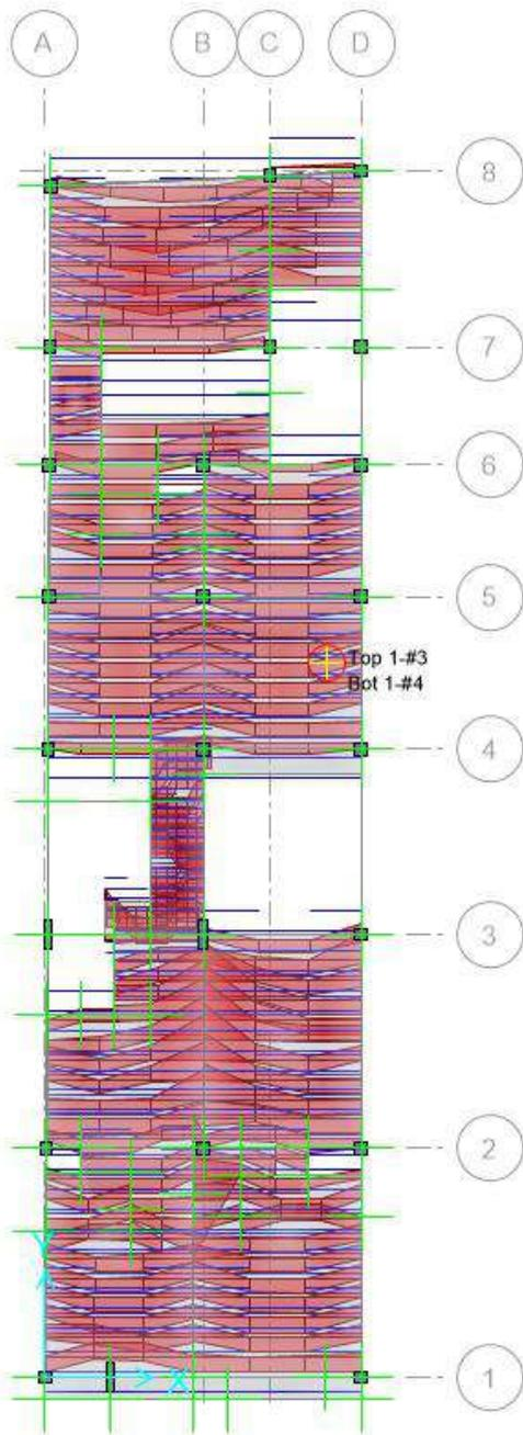
**Figura 25** Diseño de la losa aligerada del 3° piso.
