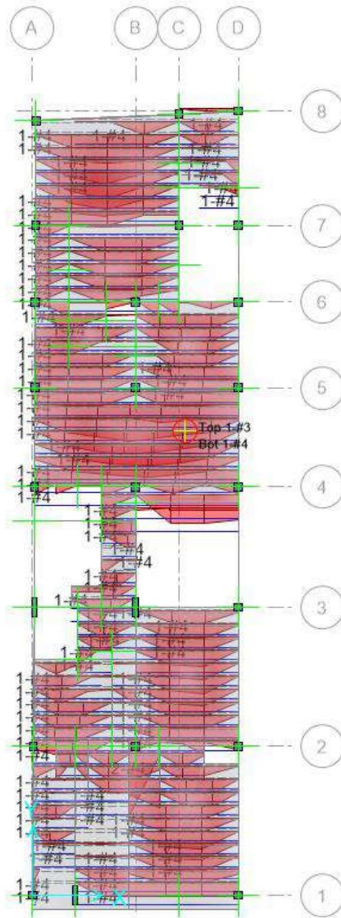
*Figura 21 Detalle del aligerado existente*
