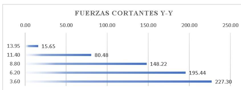
*Figura 8 Fuerzas por piso en la dirección Y-Y*
