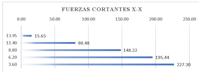
*Figura 7 Fuerzas por piso en la dirección X-X*
