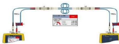
Figura: Medición de atenuación de fibra con OLTS
