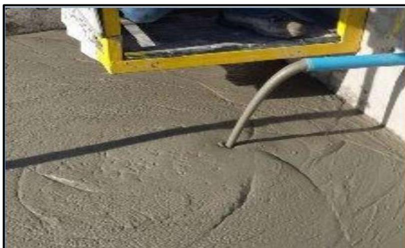
***Ilustración 16. Disposición de relave en pasta en una poza de desecado - Minera Shauxin.***
