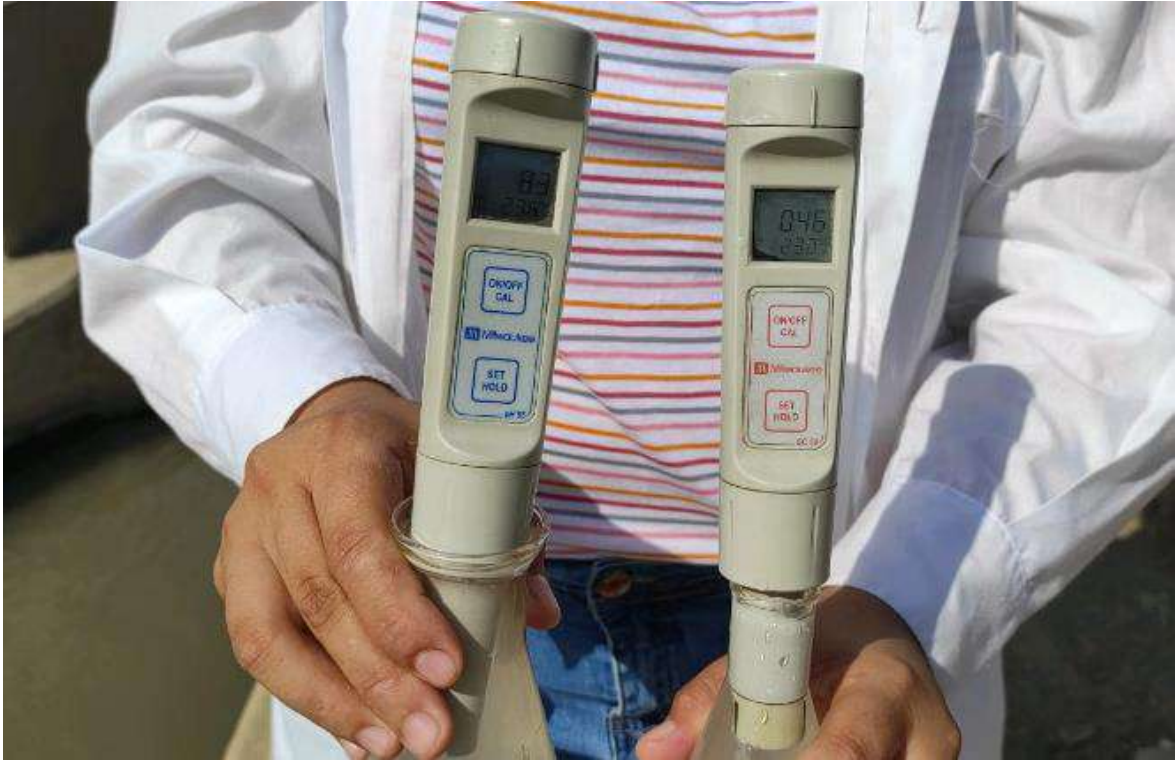
Figura 25. Medidor de pH y conductividad in situ del agua de riego.
