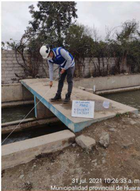
Figura 17. Muestreo de agua y conservación para análisis de metales pesados: Asup-2
