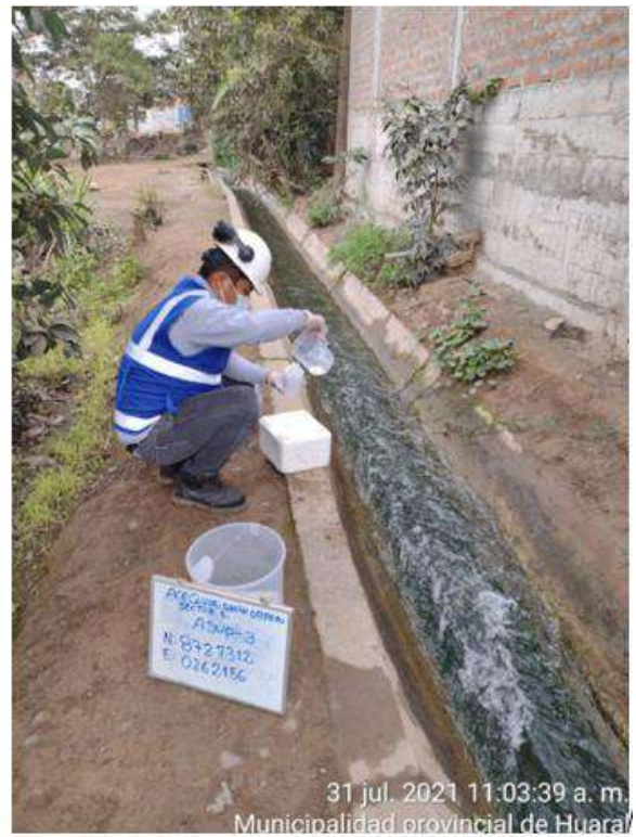
Figura 22. Muestreo de agua y conservación para análisis de metales pesados: Asup-3
