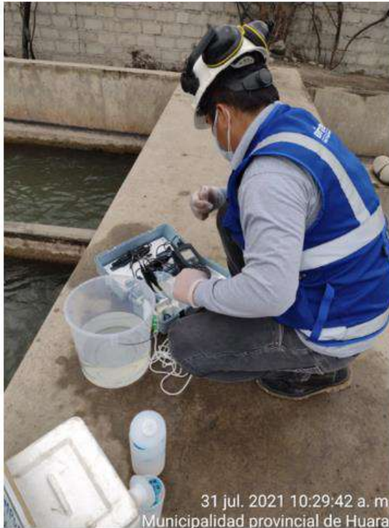
Figura 15. Preparación de muestra para análisis de agua: Asup-2
