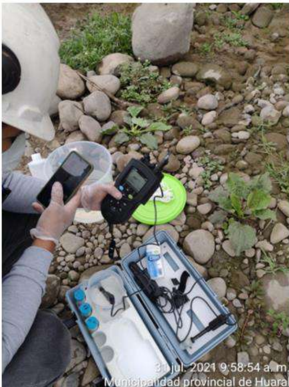
Figura 11. Lectura de parámetros del agua en campo: Asup-1
