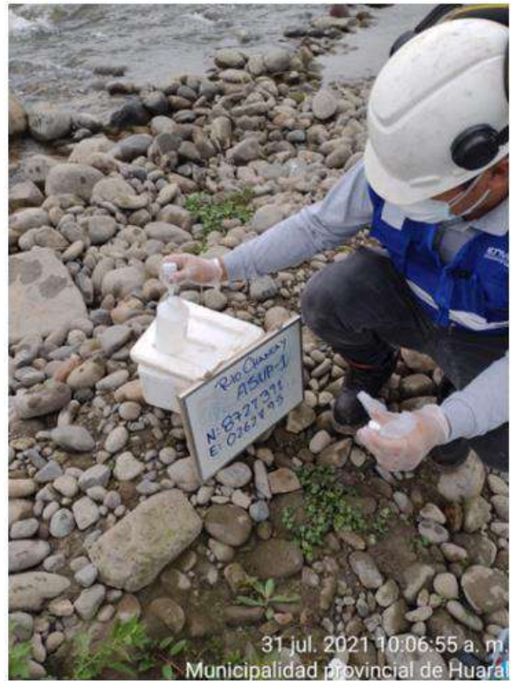
Figura 12. Muestreo de agua y conservación para análisis de metales pesados: Asup-1
