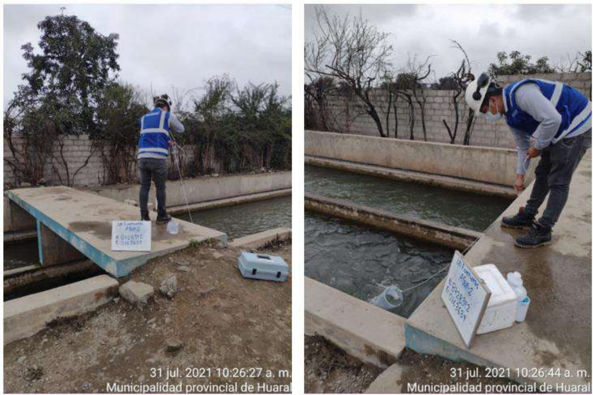
Figura 14. Muestreo de agua para análisis en campo: Asup-2
