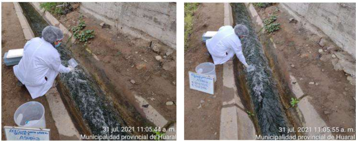
Figura 19. Muestreo de agua para análisis en campo: Asup-3
