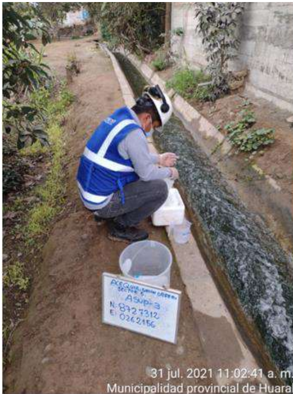
Figura 22. Muestreo de agua y conservación para análisis de metales pesados: Asup-3
