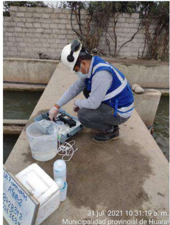
Figura 15. Preparación de muestra para análisis de agua: Asup-2
