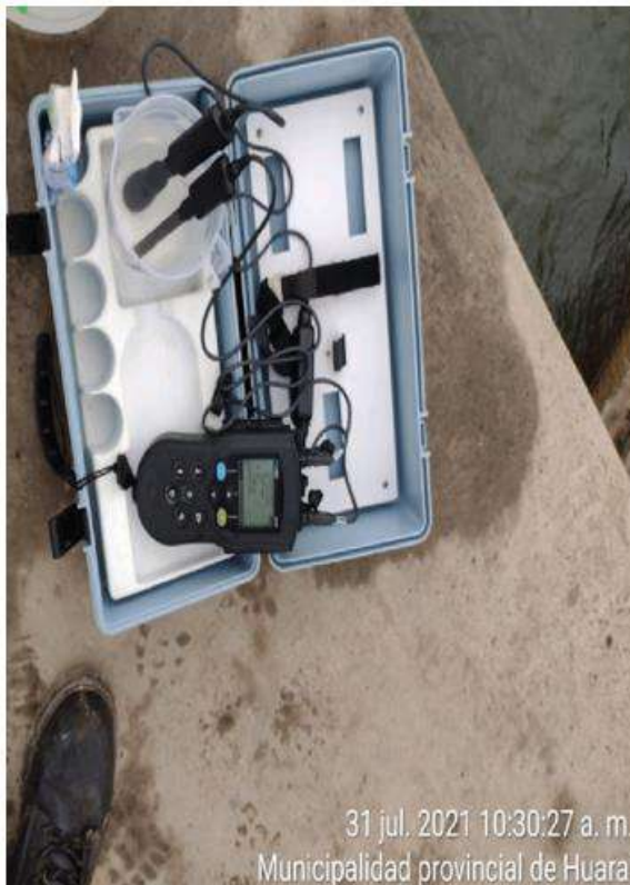
Figura 16. Lectura de parámetros del agua en campo: Asup-2
