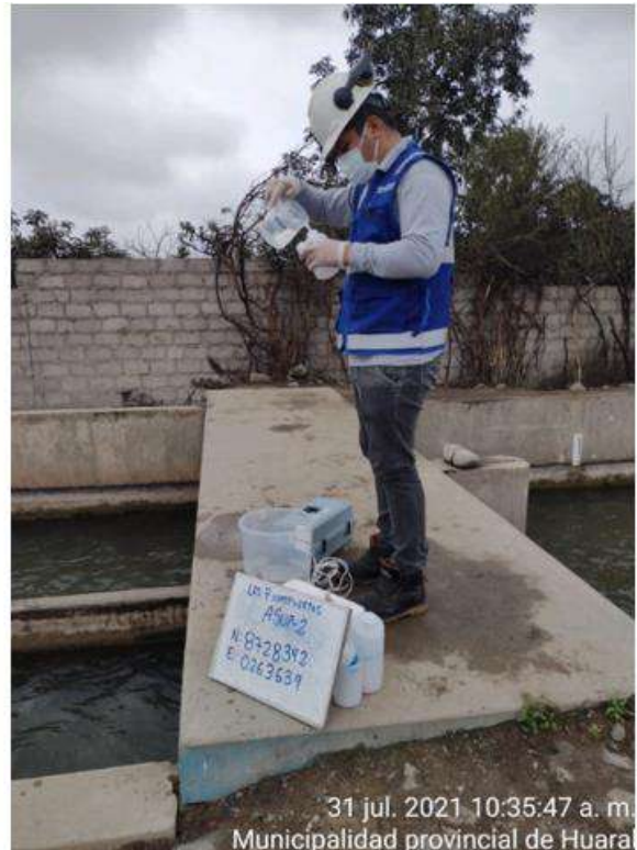
Figura 17. Muestreo de agua y conservación para análisis de metales pesados: Asup-2
