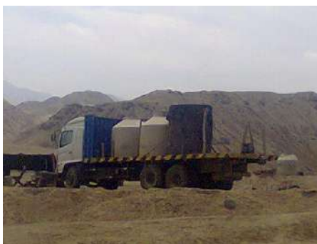
Figura N° 6: cisternas para el acarreo de agua.
