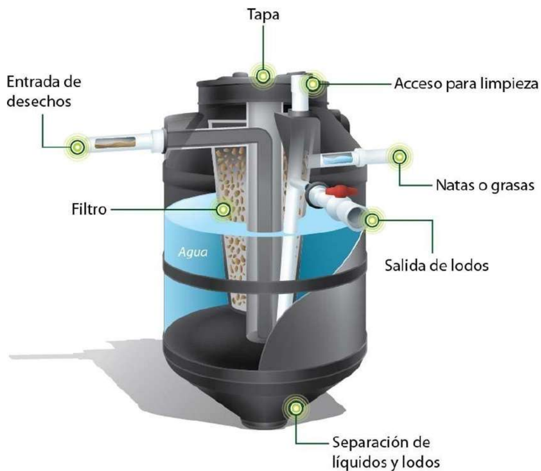
Figura 9. Tanque de biodegradación de excreta
