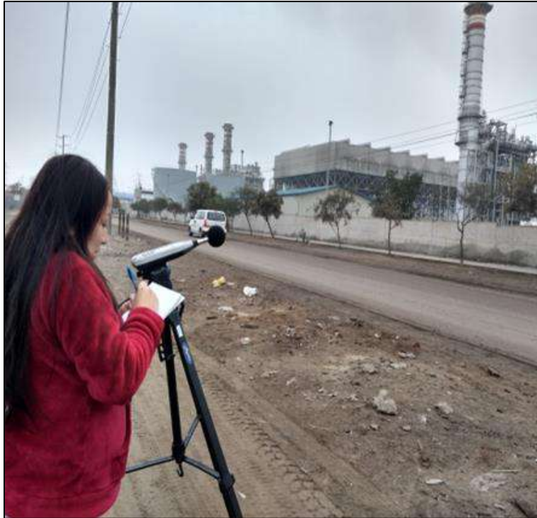
Figura 29. Foto Monitoreo de ruido ambiental en la zona industrial.
