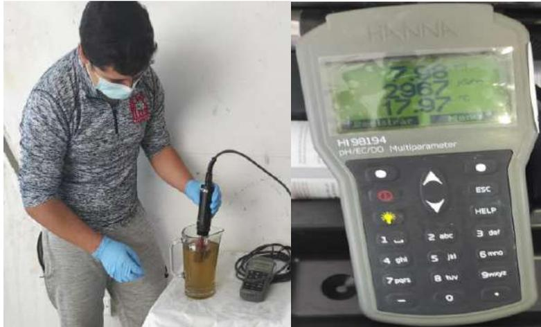
Figura 16. Medición de pH, conductividad eléctrica y temperatura después de tratamiento.
