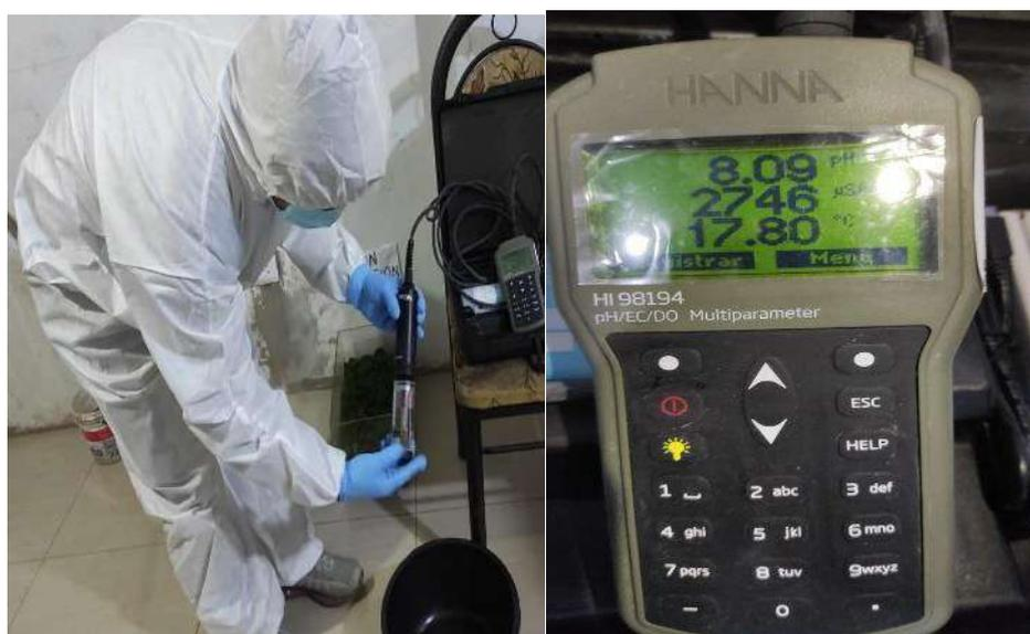
Figura 15. Medición de pH, conductividad eléctrica y temperatura antes de tratamiento.
