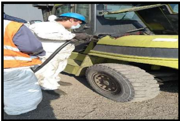
Imagen 5: Cuidado de equipos principales (Lubricación y adición de combustible)
