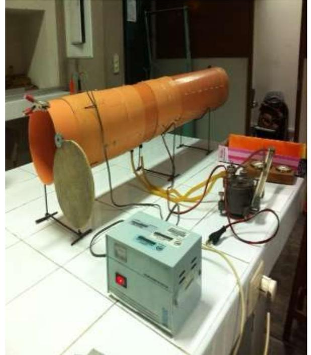
**Foto 4.** Diseño terminado del túnel de secado. Tomadas en el laboratorio de la UNJFSC.
