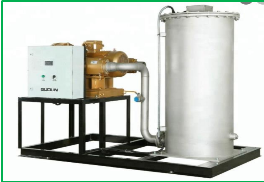
Figura Nro. 06. Catalizador térmico tipo destructor de ozono para tratamiento de agua
