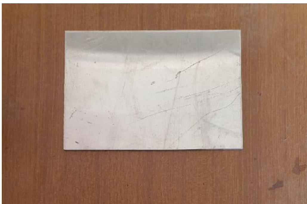
Figura 3. Dimensiones del cátodo de acero a emplear dentro de la cuba de electrodeposición.
