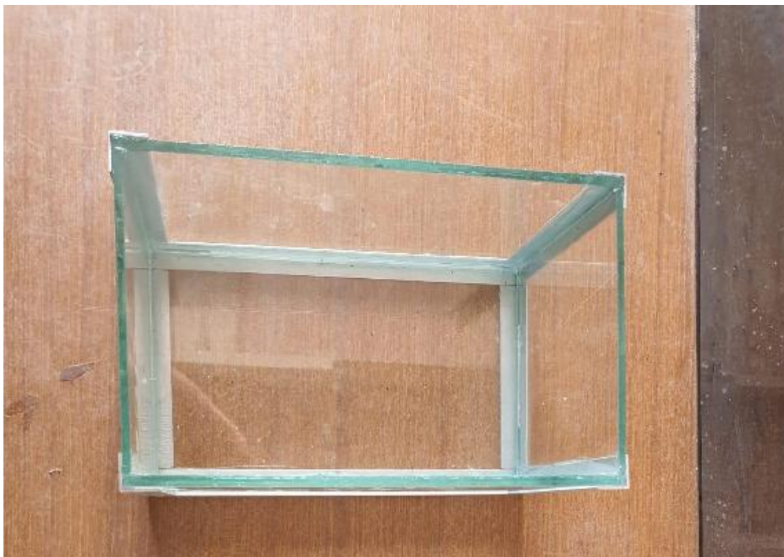
Figura 4. Cuba de vidrio con el fin de simular el proceso de Electrodeposición.
