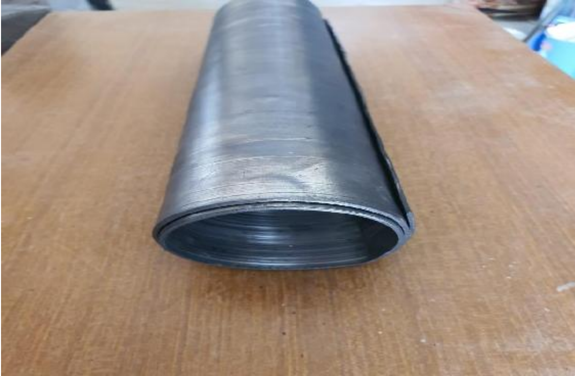
Figura 6. Lamina de plomo para utilizarlo en la electrodeposición.
