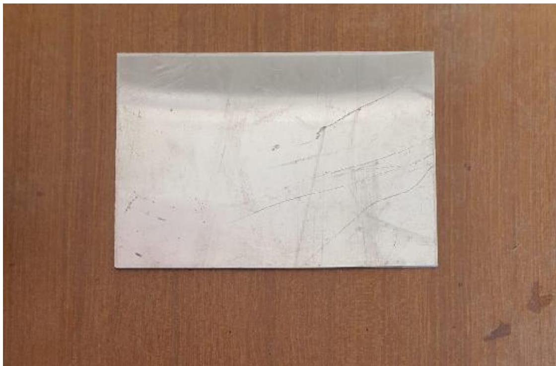
Figura 5. Cátodo de acero empleado en la electrodeposición
