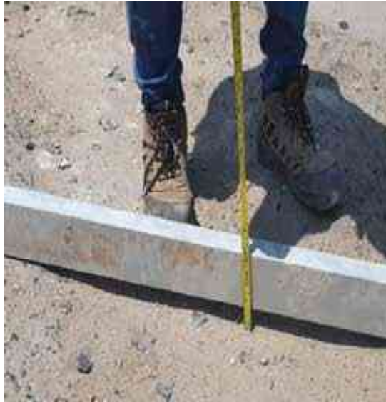
Figura 1. Identificación de falla por deformación (Fuente: propia)
