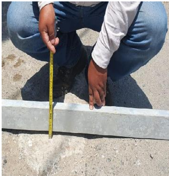
Figura 5. Detección de falla por ondulaciones (Fuente: propia)
