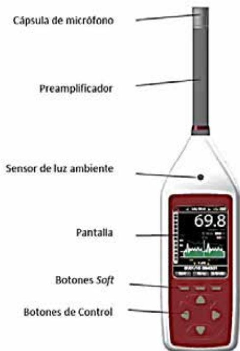
Figura 2 Componentes de un sonómetro
