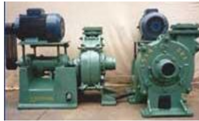
Fig. N° 2-4: bombas para transporte de pulpa
