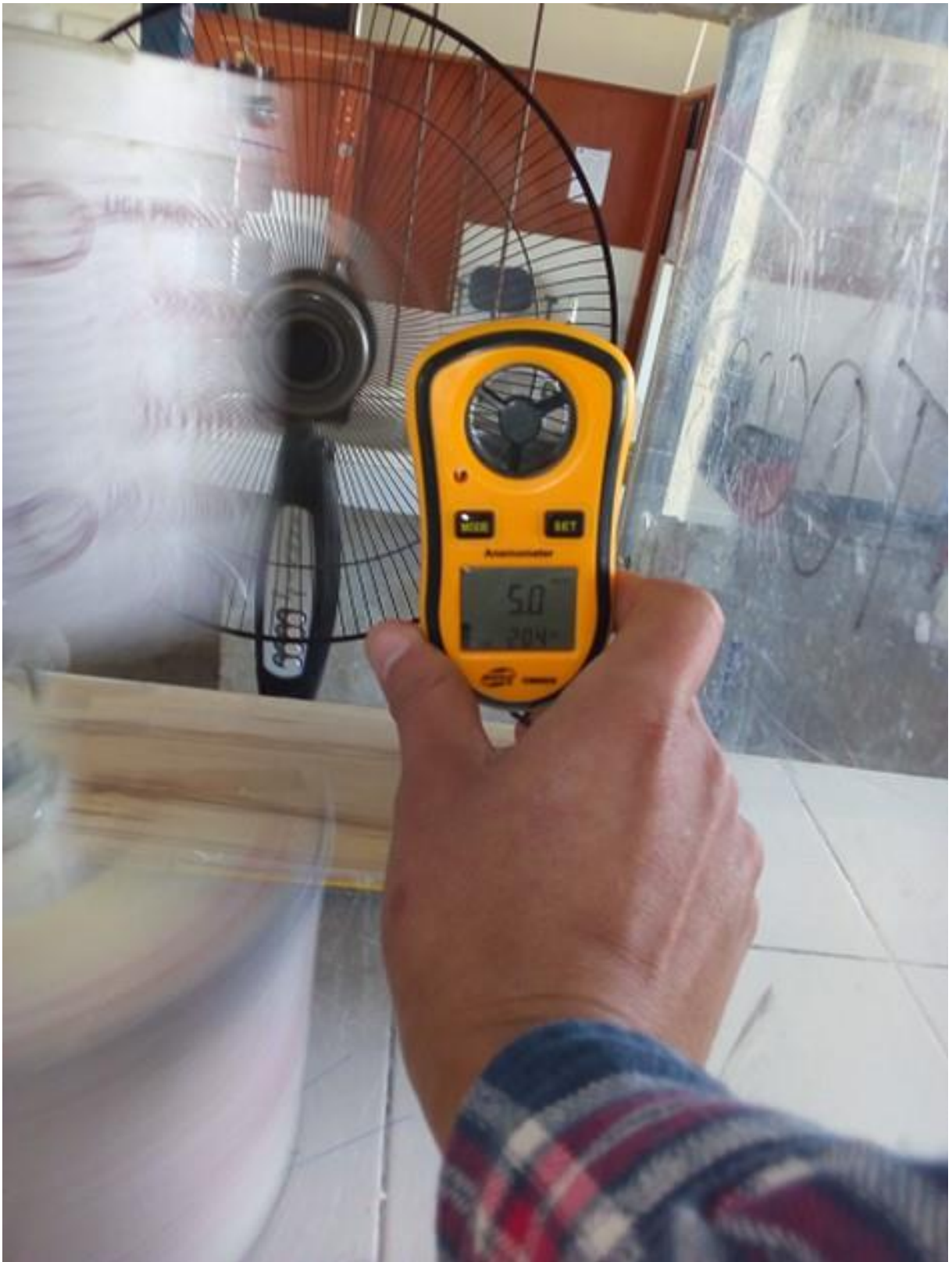
Figura 38. Medición de velocidad de viento con anemómetro digital.
