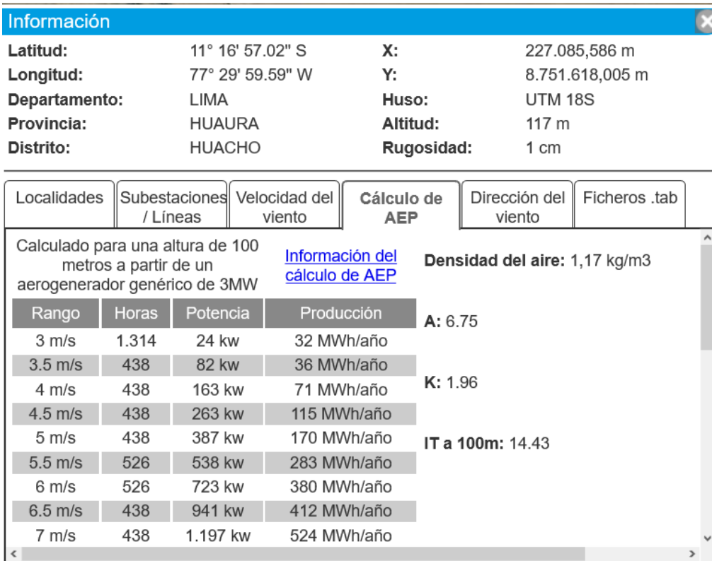
Figura 47. Número de horas por velocidad de viento en el Parque eólico proyectado. Fuente (MINEM, 2019)
