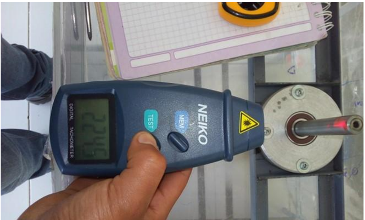
Figura 37. Medición de RPM con tacómetro digital.
