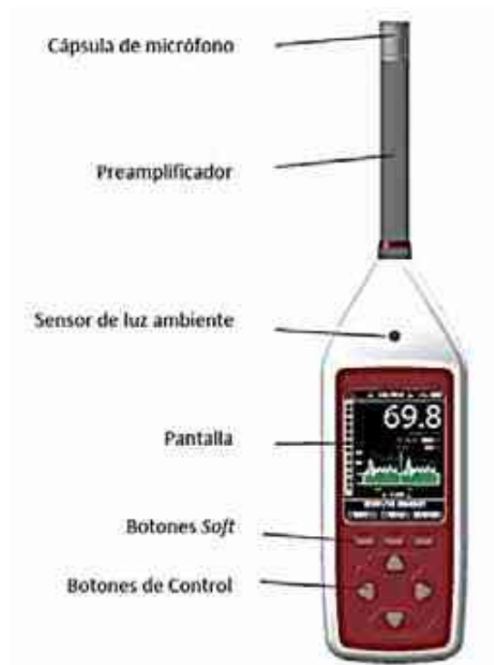
Figura 1. Componentes de un sonómetro, Recuperado de INACAL
