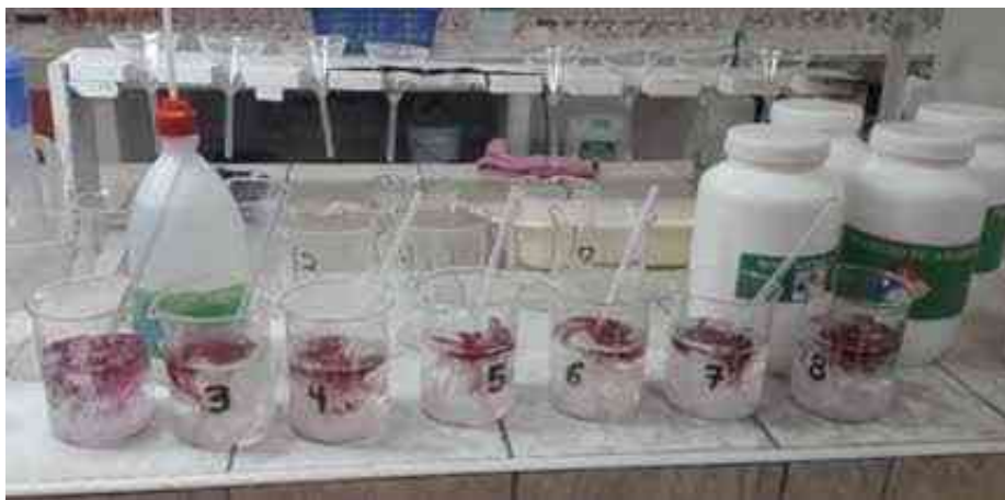
Figura 26. Muestras listas para titulación de plomo.
