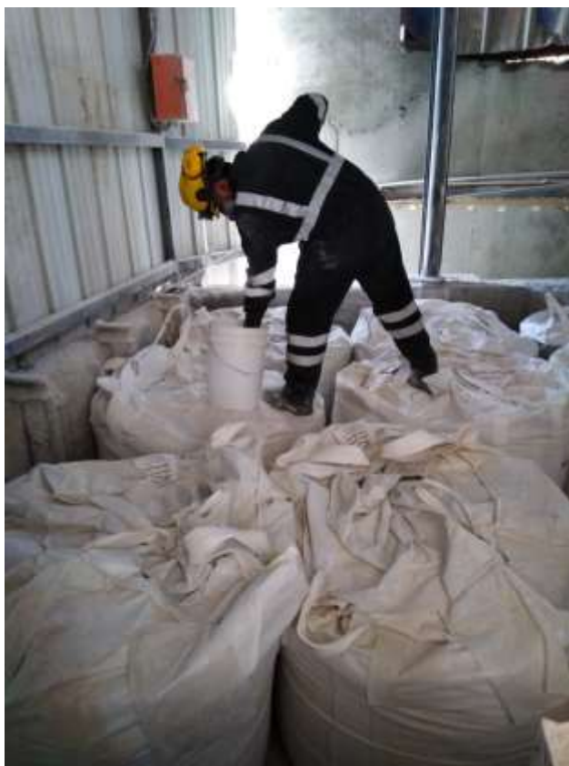
Fotografía 4: Sacando las muestras por punzones en cada bolsa de cal.
