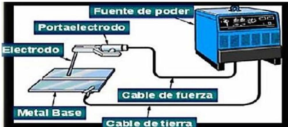
**Figura 2.** Diagrama del equipo de SMAW
