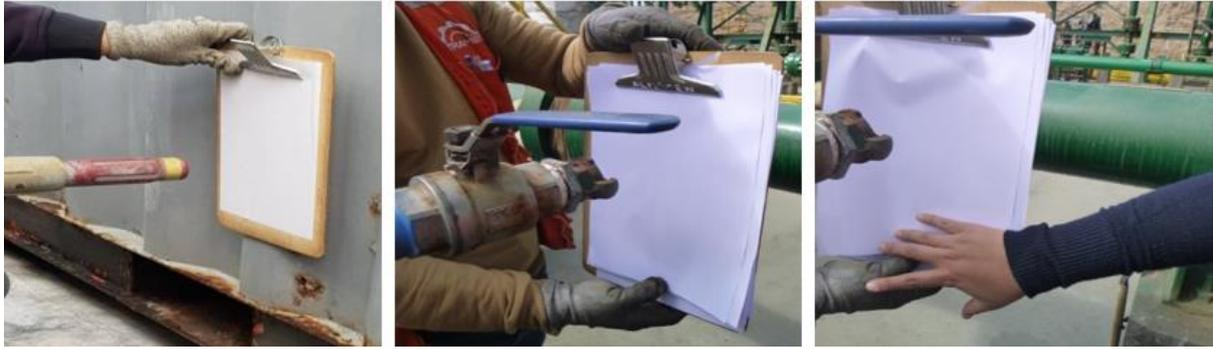
*Figura 5.* Prueba de polvo de verificación de ausencia de agua y grasa en el aire comprimido.
