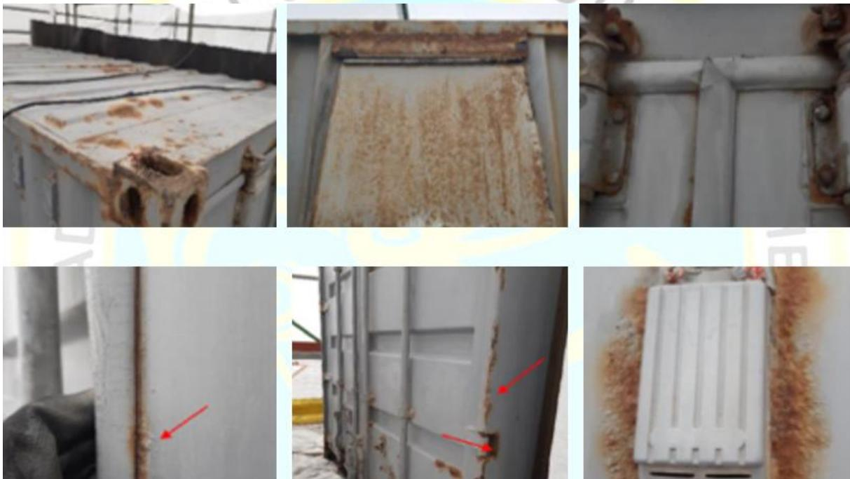
*Figura 9.* Presencia de corrosión en distintas áreas del container
