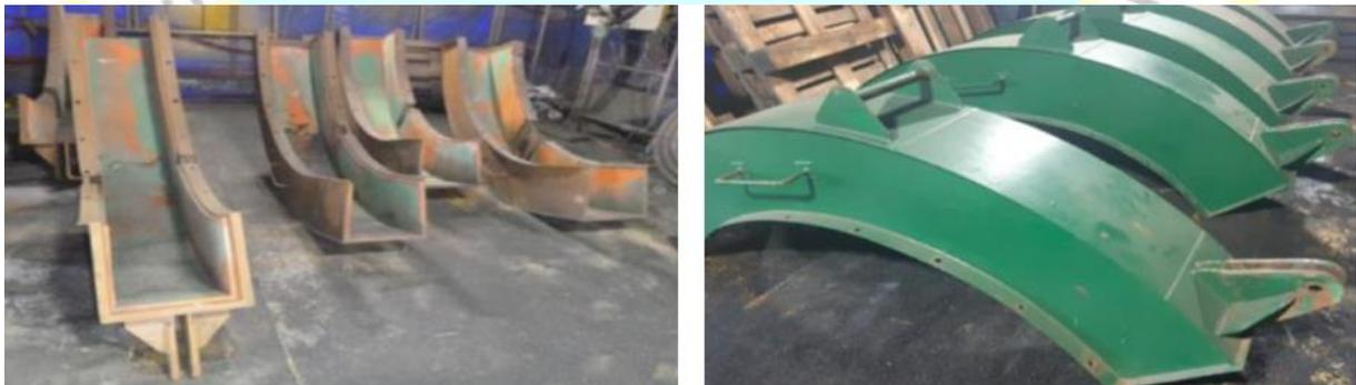
Figura 23. Cobertores antes de la preparación de superficie
