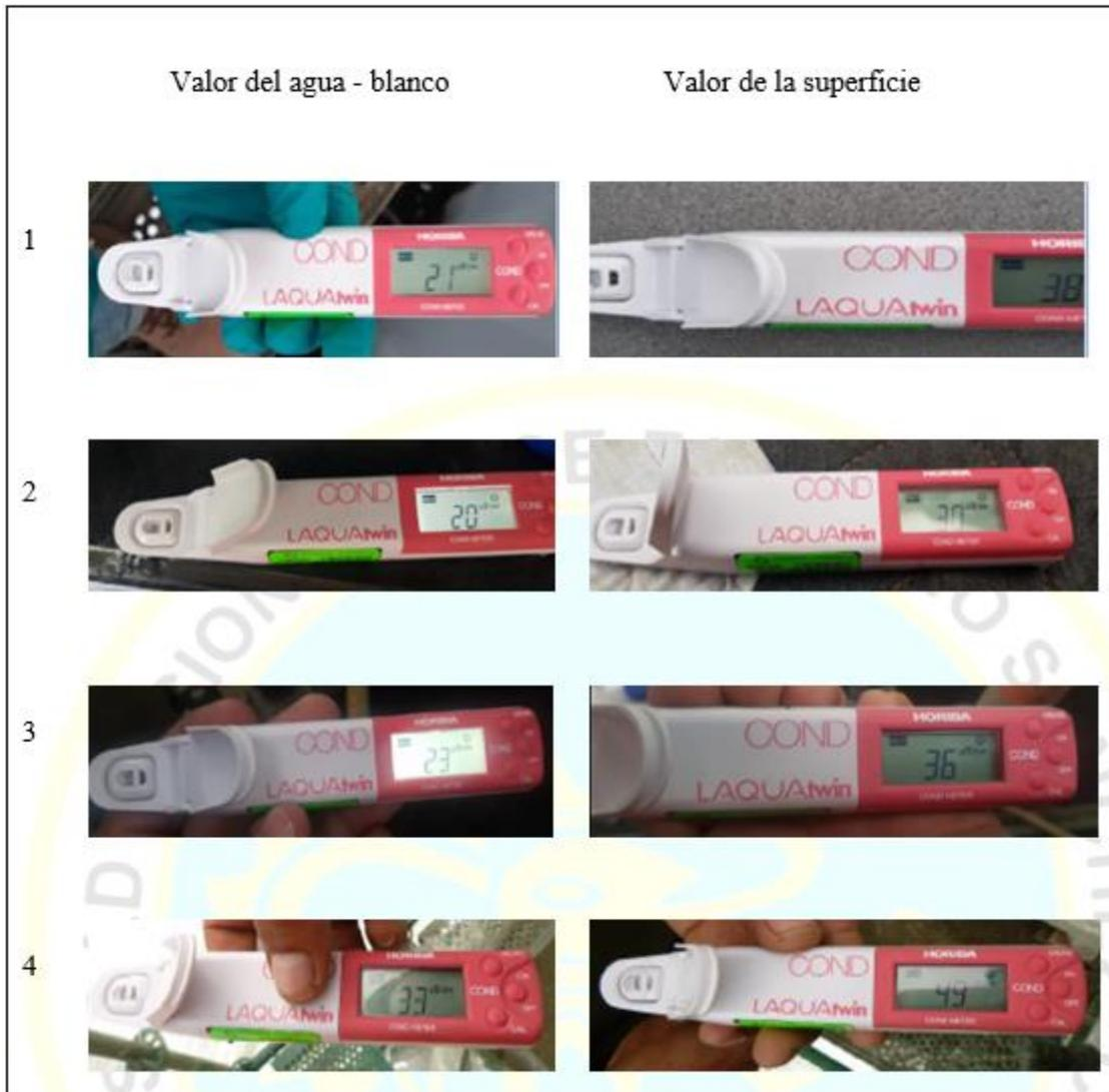
Figura 10. Valores del blanco y superficie para la prueba de Parche Bresle en container.
