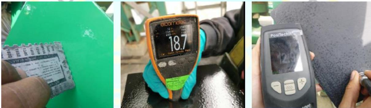
Figura 32. Control de espesor durante el pintado y en seco.
