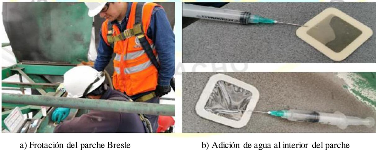
Figura 8. Prueba Bresle para la medición de la conductividad en superficie lavada.
