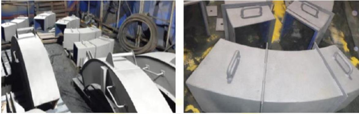
Figura 24. Superficie preparada de cobertores después del escoriado
