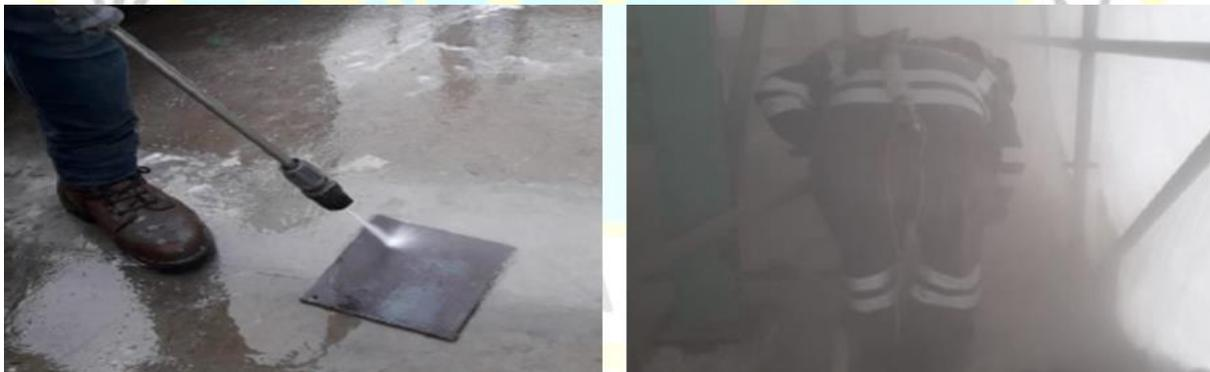
*Figura 33. Lavado y chorreado de la probeta.*
