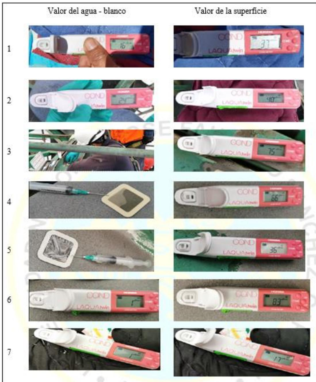
Figura 12. Valores del blanco y superficie para la prueba de Parche Bresle en estructuras
