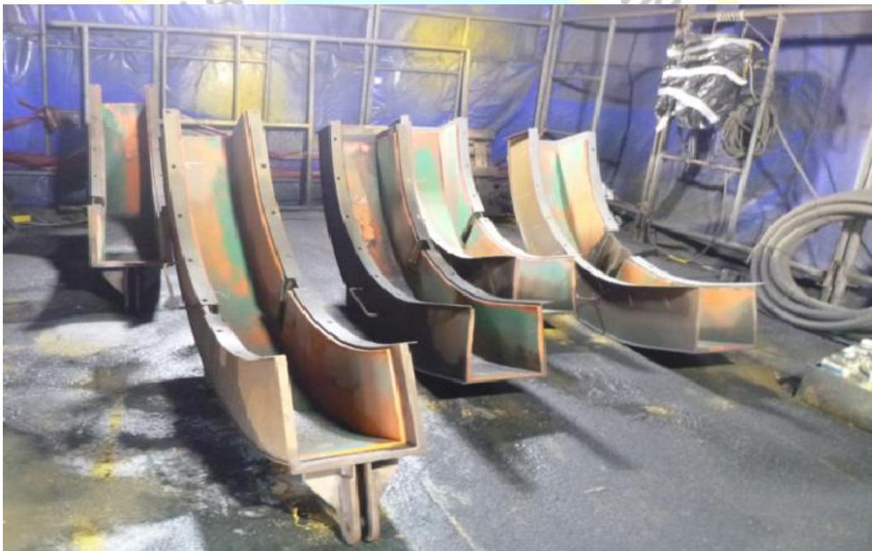
*Figura 13.* Presencia de óxido después del lavado de cobertores.
