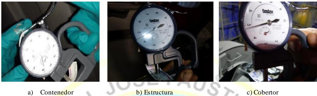
Figura 18. Medidor de rugosidad de perfil de anclaje en mils.
