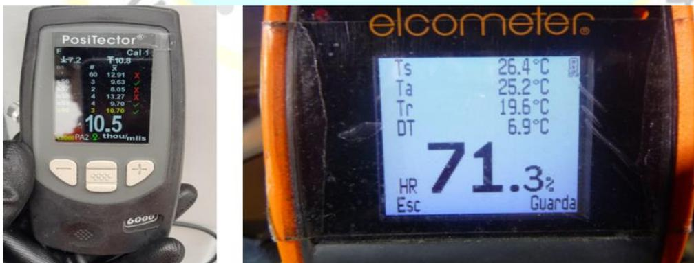
Figura 25. Medidores de las condiciones ambientales
